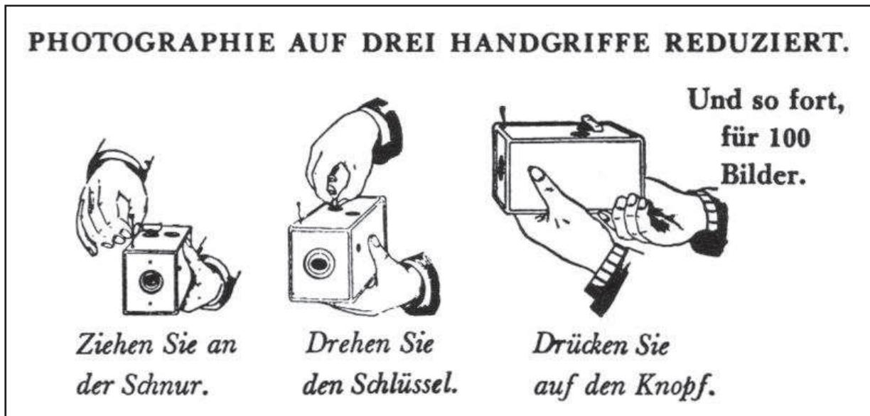
Abb. 8: Bedienungsschritte für das Fotografieren mit der Kodak Nr. 1 (1889)
