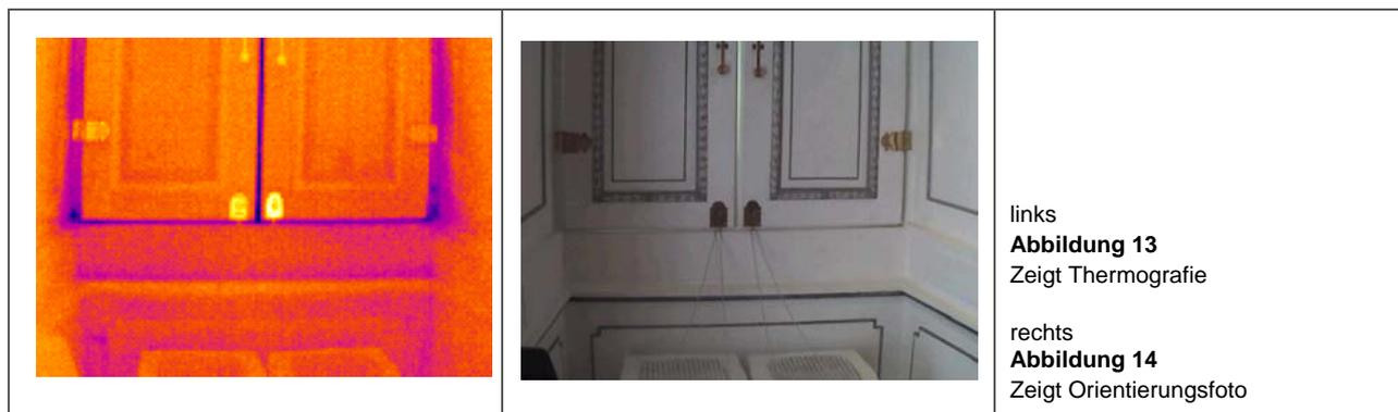
In einem ersten Analyseschritt werden Messpunkte gesetzt, um die verschiedenen Farben des Bildes, die die Temperaturen abstuft, besser lesen zu können.
