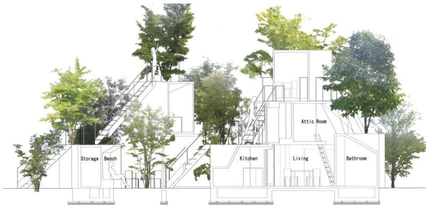
Sección longitudinal Oeste / West longitudinal section
