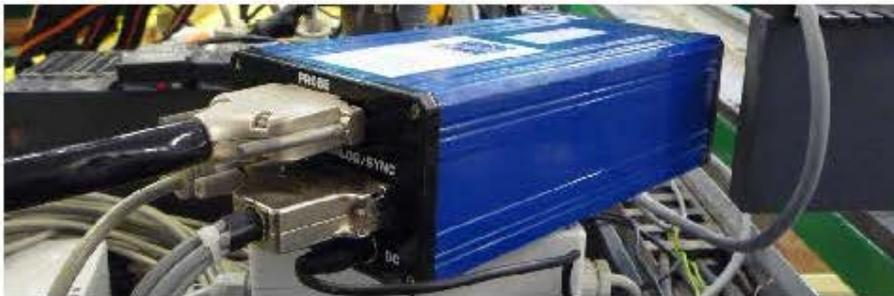
Abb. 4.16 ADV Datenerfassungsgerät der ADV – Sonde
