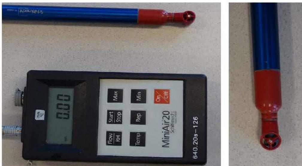
Abb. 4.14 Geschwindigkeitsmessflügel (OMNI INSTRUMENTS, 2009)
