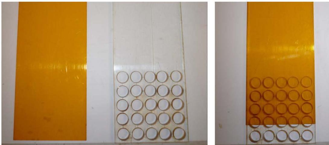
Abb. 4.12 Schieberplatte und Lochblende für Turbinendurchflussregulierung
