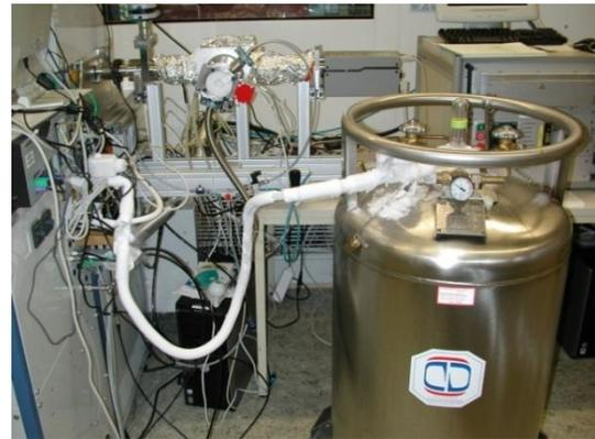
(b) Angeschlossener Tank mit flüssigen Stickstoff
