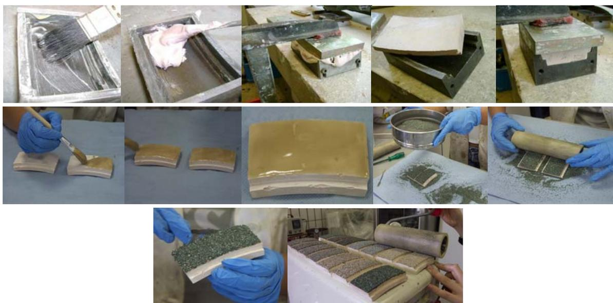
**Abb. 5-13: Bilddokumentation der Sandprobekörperherstellung für die Anwendung in der Schnellpoliermaschine und dem Pendelgerät**
