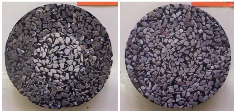
Abb. 3-24: Splittprobekörper hergestellt nach dem Splitt-Mastix-Eingussverfahren
