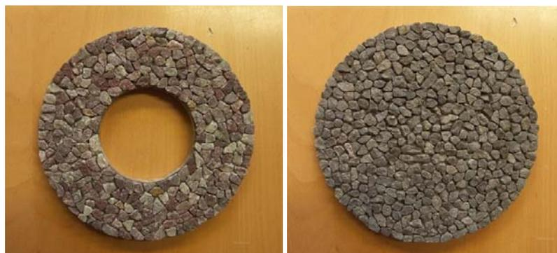
Abb. 3-22: Splittprobekörper mit und ohne eingelegtem Platzhalter nach dem Mosaikauslegeverfahren
