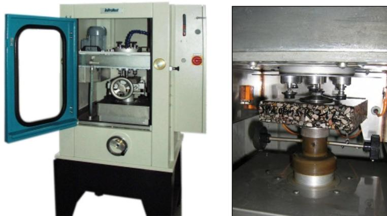
Abb. 3-33: Das Polier- und Griffigkeitsmessgerät PGM [GAUER, 2010] bzw. Detailansicht der Polier- und Griffigkeitsmessstößel [RAUSCHENBACH und BOREK, 2010]
