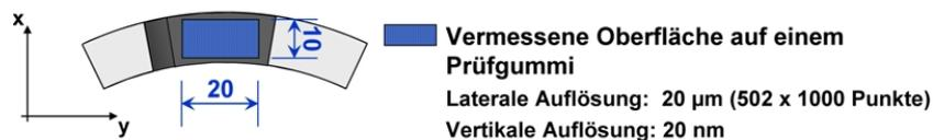
Abb. 4-30: Anordnung der Prüffläche auf einem Prüf gummi - Maße in [mm]
