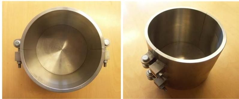
Abb. 3-23: Zylindrische Metallschalung für die Probenherstellung
