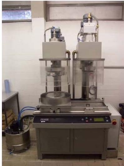
**Abb. 3-4: Prüfanlage nach Wehner/Schulze - Version 2 der Fa. BPS Wennigsen<sup>35</sup>**
