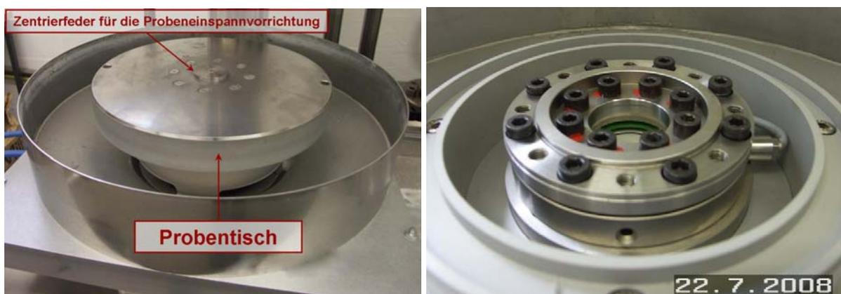
**Abb. 3-15: Verfahrenbarer Probentisch im Betriebszustand (links), Geöffneter Probentisch mit Darstellung der eingebauten Referenz-Drehmomentmessscheibe**
