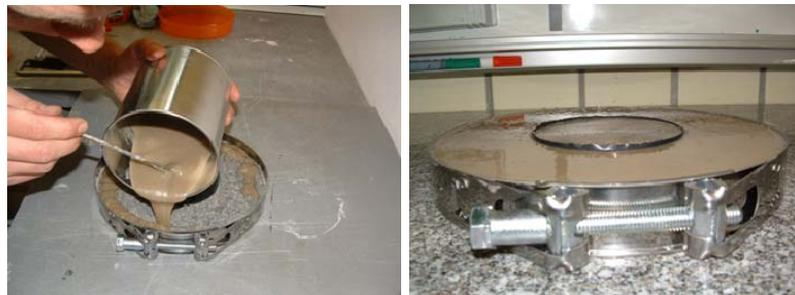
Abb. 3-21: Auffüllen der Schalform mit einem Klebstoff-Quarzmehl Gemisch
