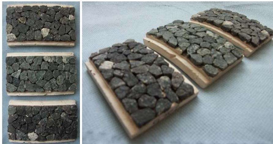
Abb. 3-31: Prüfkörper für die Bestimmung des PSV-Wertes [KIRCHMAIER et al., 2010c]
