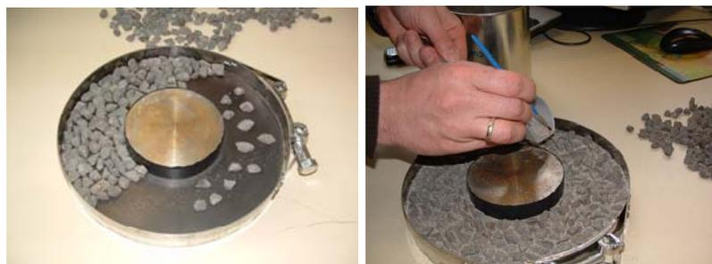
Abb. 3-19: Auslegen und Verfüllen der Splittkörner
