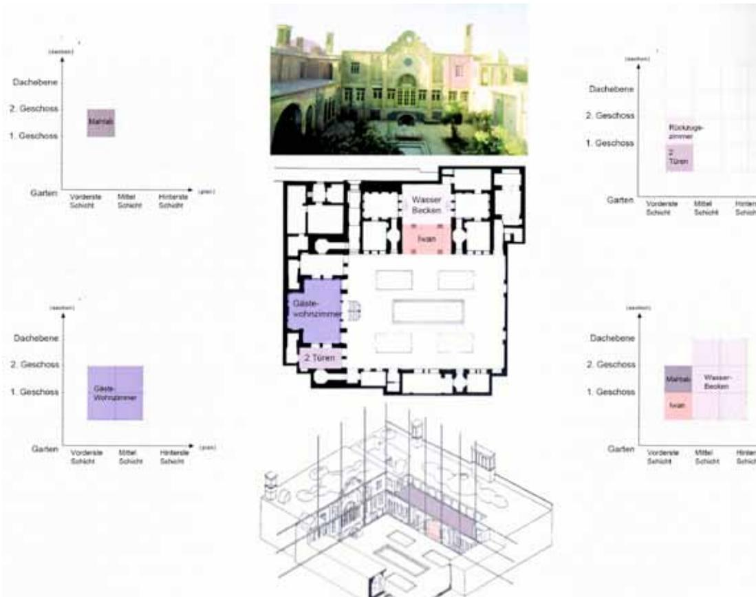
Abb. 33, Aufbau eines traditionellen iranischen Hauses anhand unsichtbarer Achsen am Beispiel eines Hauses in Kashan
