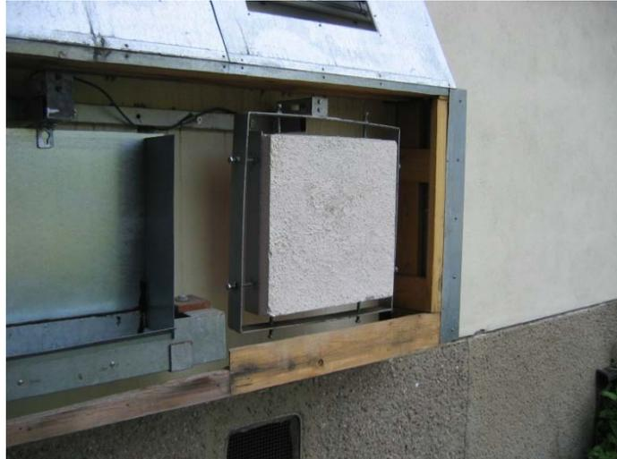
Abb. 19 – Schlagregennesstelle mit hochgeklappter Metallverblendung
