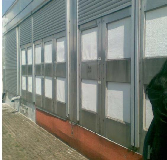
Abb. 12 – Schlagregennessanlage für Außenputze des Fraunhofer-Instituts für Bauphysik in Holzkirchen
