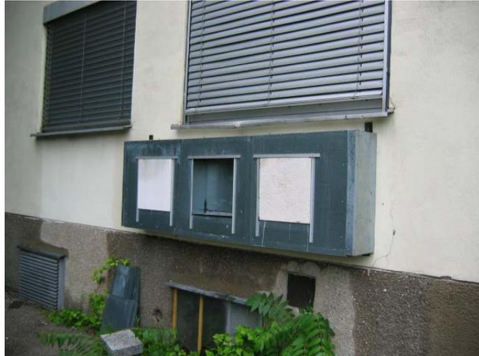
Abb. 16 – Schlagregennesstelle an der Nordwestfassade des Laborgebäudes des Forschungsbereichs für Bauphysik und Schallschutz der TU Wien
