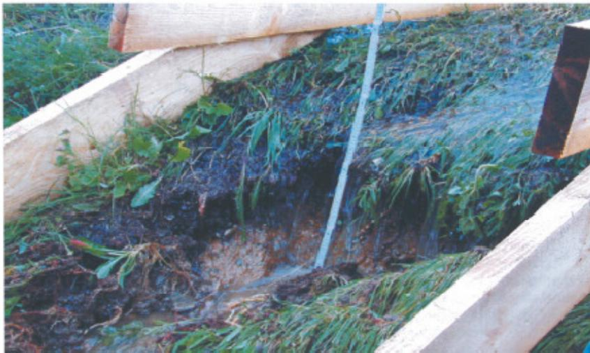
**Abbildung 3.13:** Oberflächenerosion bei der Nullvariante [25]
