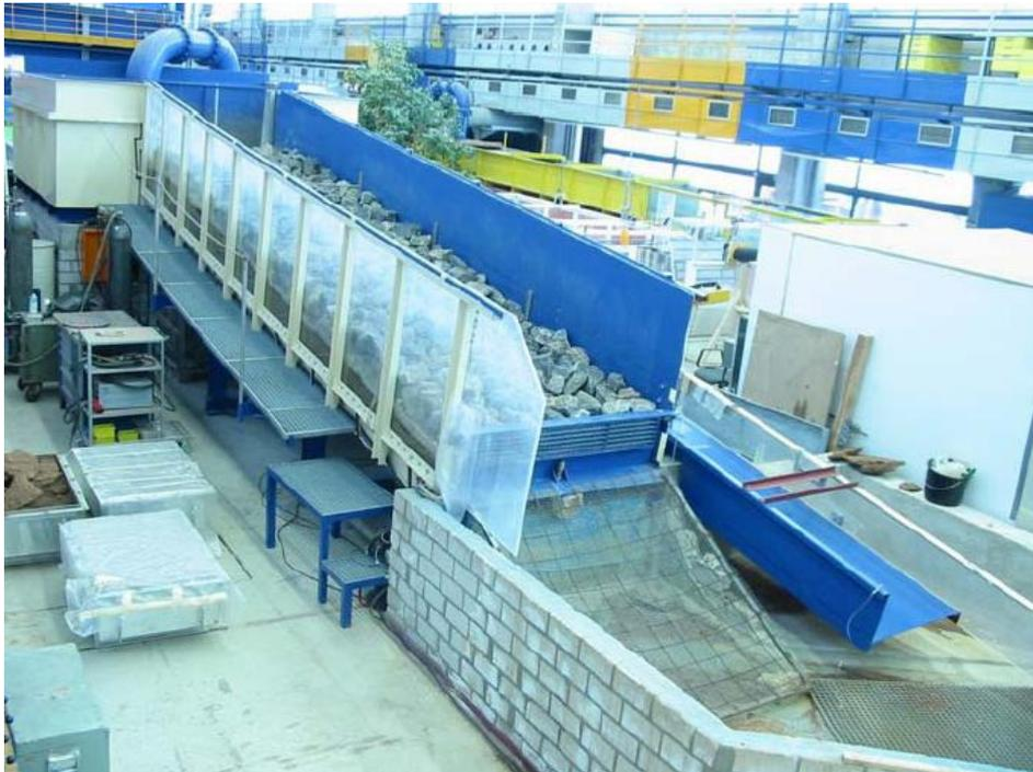
**Abbildung 5.7 :** Versuchsrinne für die großmaßstäblichen Modellversuche zu der Steinschüttung [5].
