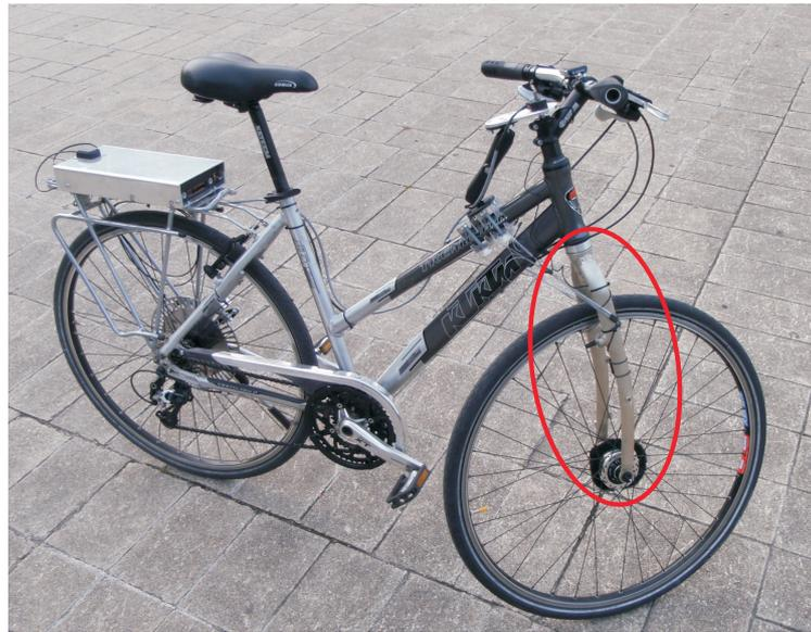
Abbildung 6.36: Testfahrrad mit umgedreht eingebauter starrer Gabel
