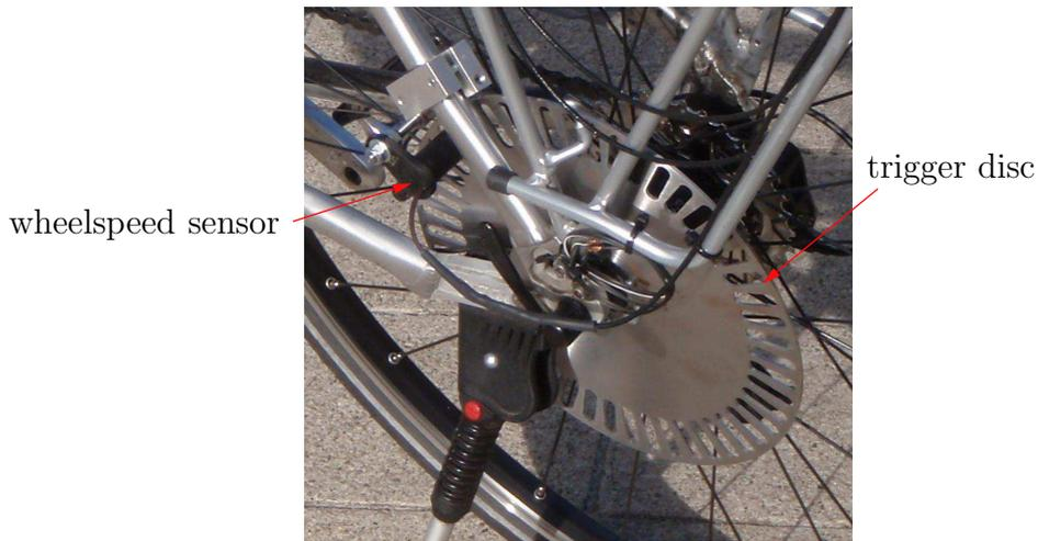
Abbildung 5.2: Drehzahlsensor bei Hinterrad
