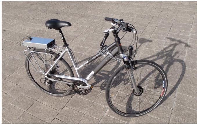
Abbildung 5.1: Testrad mit Messausrüstung
