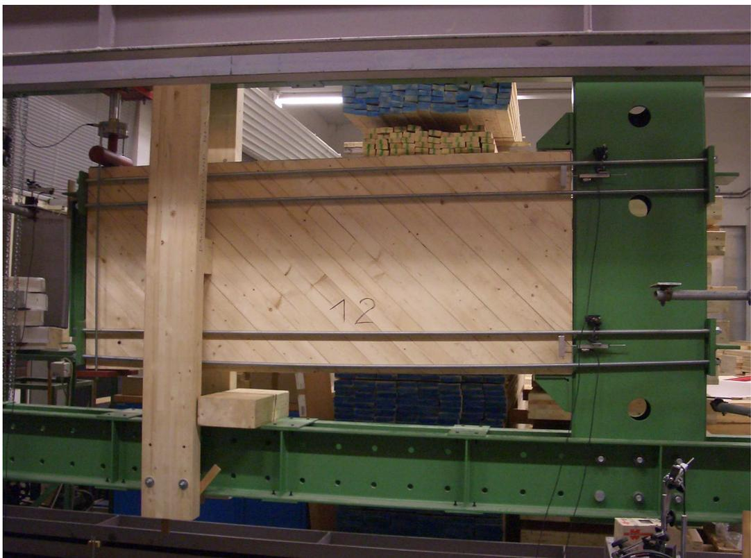
**Abbildung 56: Zyklischer Test der Wand 12**
