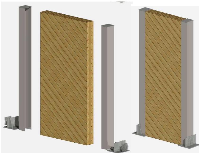
**Abbildung 59: Wand 14, 15 mit Stahlzugelementen**
