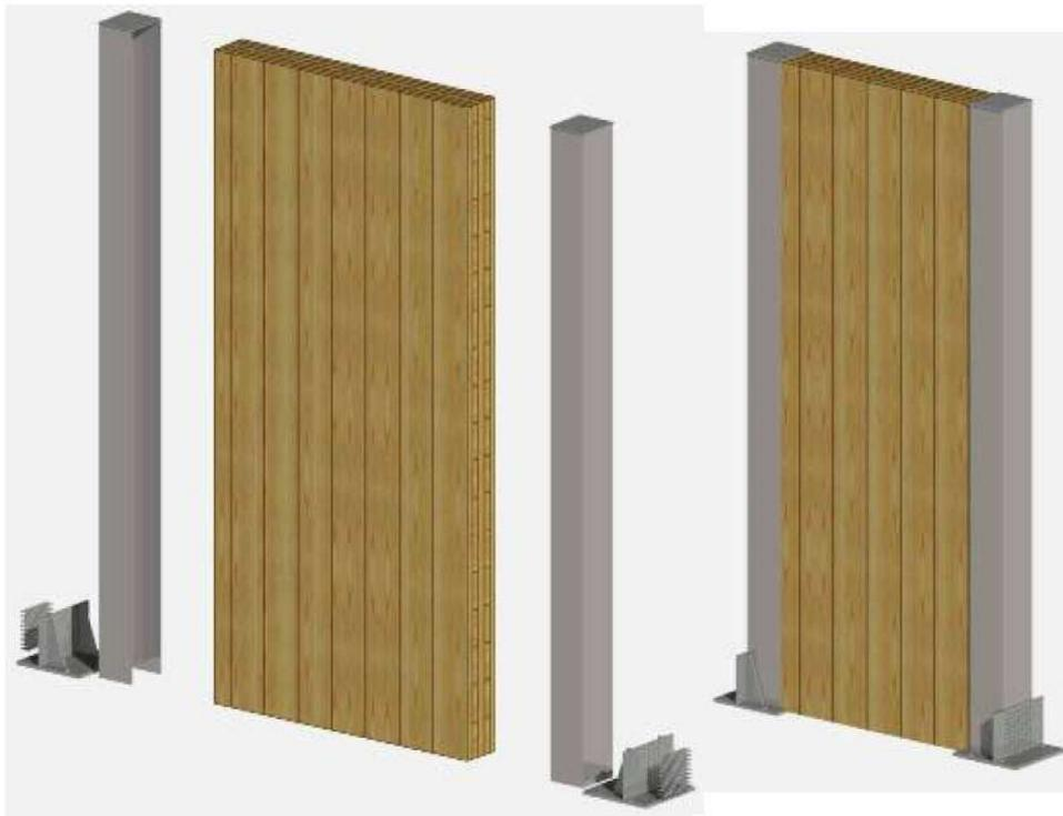
**Abbildung 58: Wand 13 mit Stahlzugelementen**
