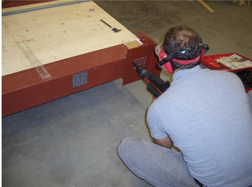
**Abbildung 27: Befestigung der Stahlschuhe auf den „Verbundprüfkörper“ für zyklische Versuche mittels Hilti-nägeln.**
