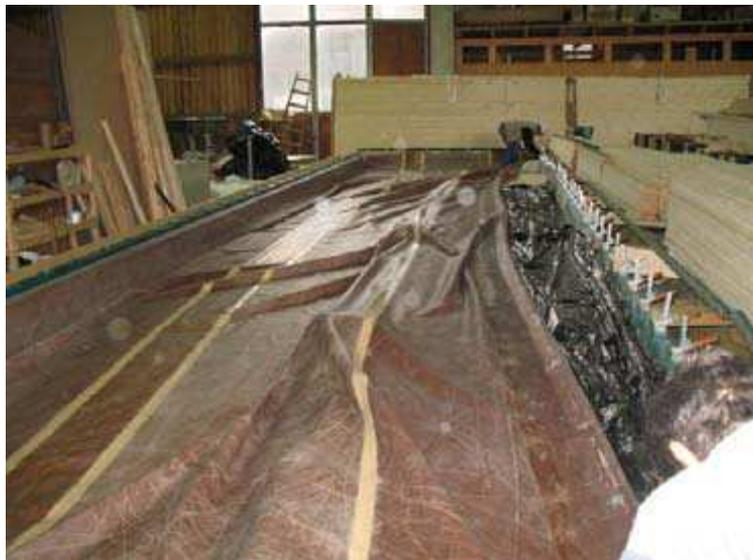
**Abbildung 20: Vakuumpresse**
