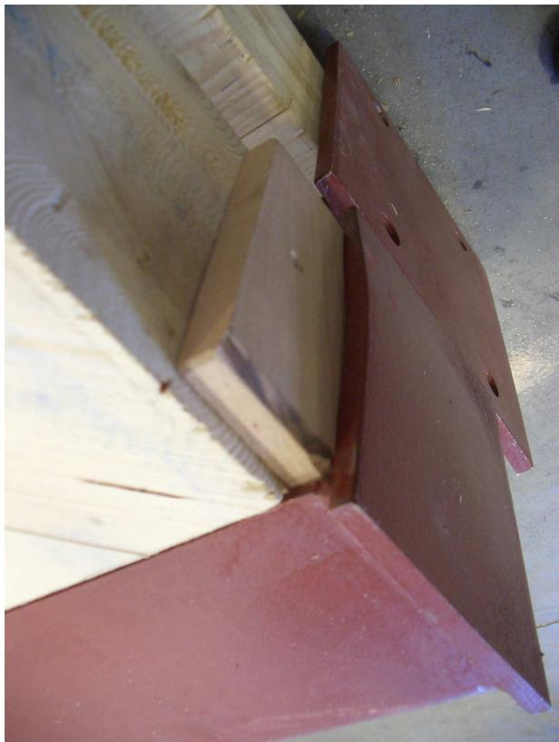
**Abbildung 67: Plastifizierung der oberen Stahlplatte**
