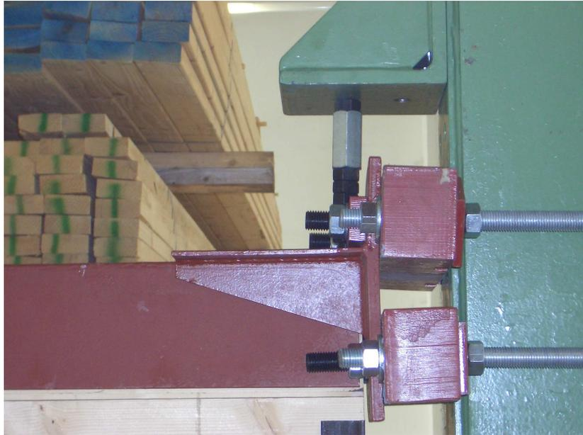
**Abbildung 66: Plastifizierung der unteren Stahlplatte:**
