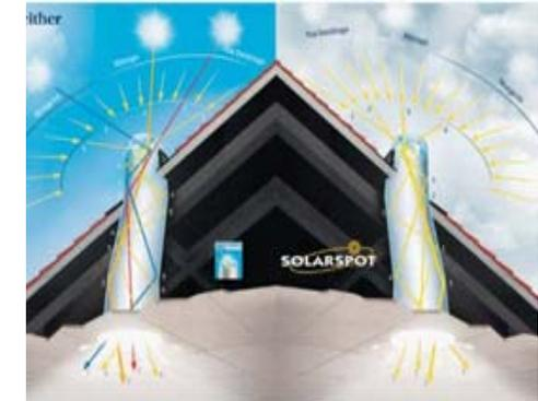
Abb. 159 Rohrdachfenster der Firma Solarspot
