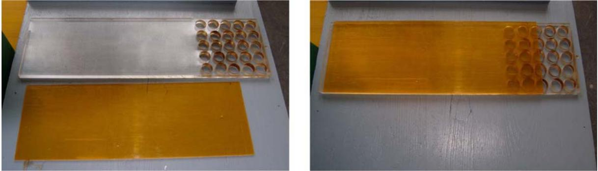
Abbildung 5.7.: Lochblender zur Regelung des Turbinendurchflusses
