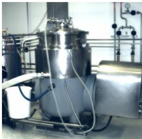
**Abbildung 39: Zentrifuge (Separator)**
