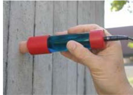
Abb. 4.1: Standard Stabelektrode der Fa. Proceq
