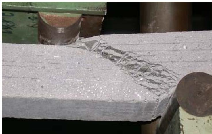
**Abbildung 2.15: 4-Punkt-Biegezugversuch mit stahlfaserverstärktem UHPC**
