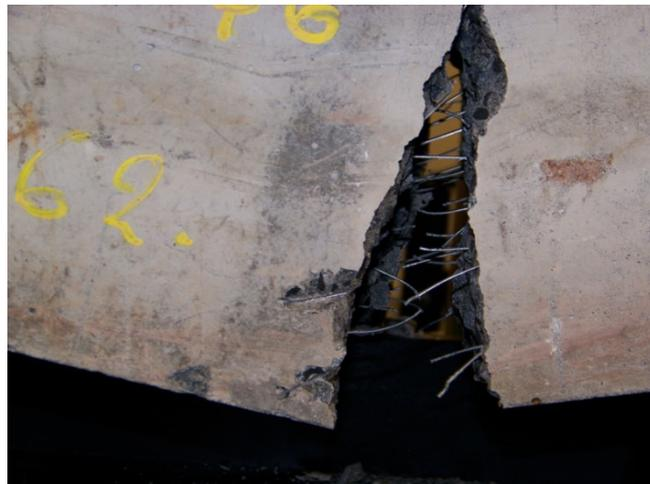
**Abbildung 2.8: Resttragfähigkeit nach Versagen**
