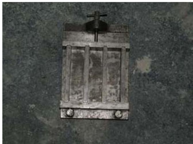
Abbildung 3.15: Schalungsform nach ÖNORM EN196-1
