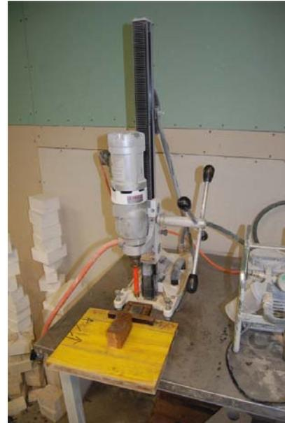
Abbildung 3.23: Steinsäge zum Sägen der Betonscheiben; Abbildung 3.24: Kernbohrer für die Probestücke
