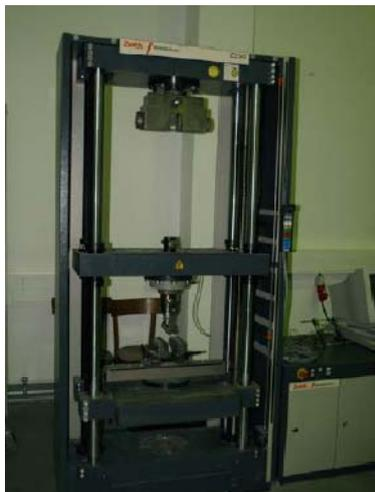
Abbildung 3.19: Prüfmaschine Zwick Z250
