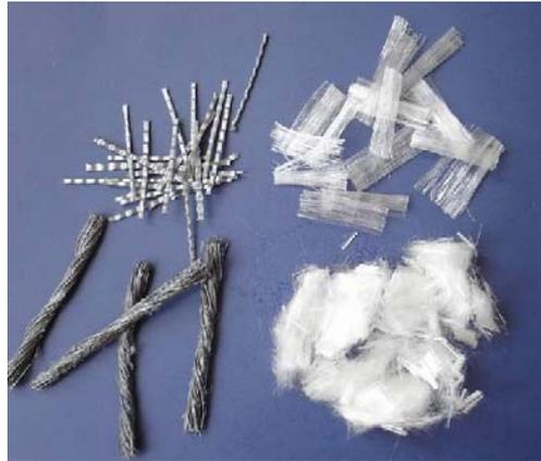
**Abbildung 2.6: Beginnend von oben links: Stahldrahtfaser gewellt, AR-Glasfaserfilamente, Stahldrahtfaser gebündelt, Polypropylenfaser**
