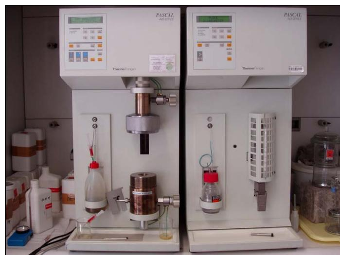
Abbildung 3.25: v.l.n.r.: Hochdruckmessstation PASCAL 440, Niederdruck-Porosimeter PASCAL 140
