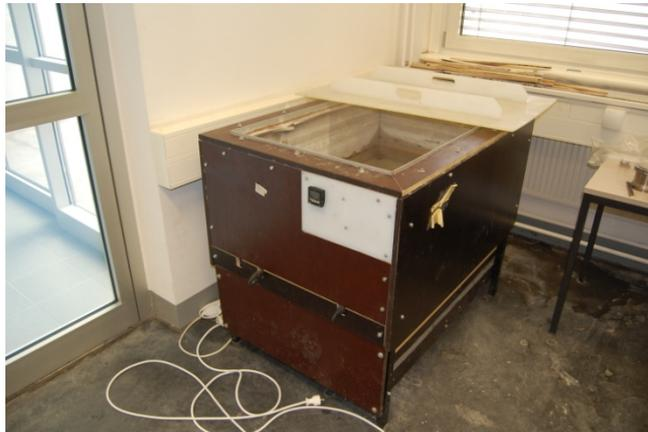
Abbildung 3.18: Warmwasserbecken für die Heißwasserlagerung
