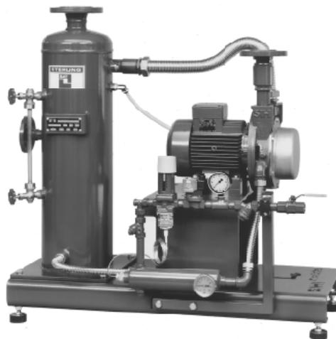
Abbildung 3.7: Foto einer Flüssigkeitsringpumpe Typ *PL 26 M.A.M 15 0.0 A* der Fa. Sterling [34]
