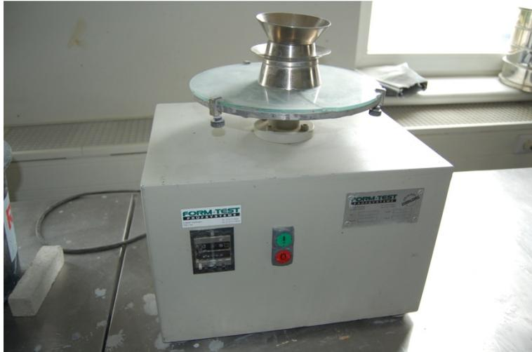
Abbildung 3.14: Ausbreittisch zur Ermittlung des Ausbreitmaßes
