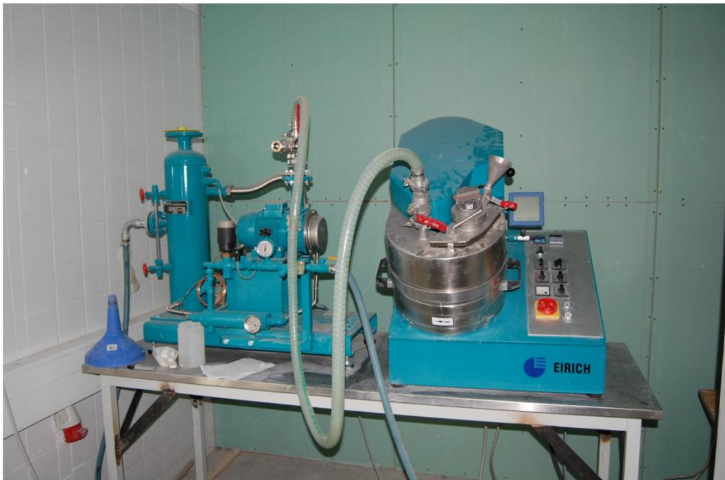
**Abbildung 3.1: Intensivmischer R 02/VC, Bj 2008 der Firma Eirich mit angeschlossener Kompakt-Vakuumanlage PL 26 M.A.M 15 0.0 A der Firma Sterling**
