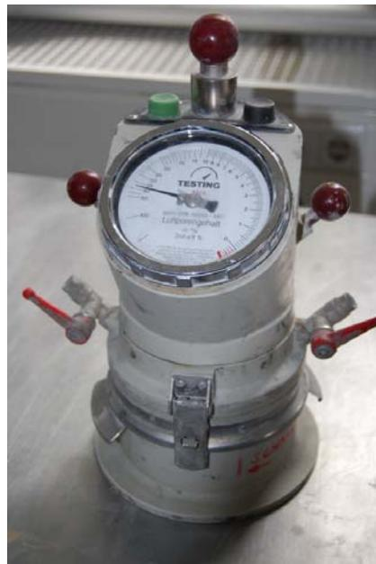
Abbildung 3.13: Luftporentopf zu Bestimmung des Luftgehalts des Frischbetons
