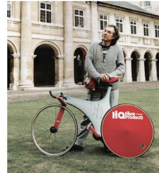
Die Kohlefaser hält Einzug im Rahmenbau. Futuristisch anmutende Zweiräder werden konstruiert. Im Windkanal optimiert und durch den Einsatz moderner Materialien wurde das Fahrrad auf eine neue Stufe der Entwicklung gehoben.
