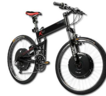
Material und technische Errungenschaften haben das Fahrrad zu einem versierten Alltagsgegenstand gemacht. Vor allem der Antrieb wird ständig weiter entwickelt. Aufgrund von leistungsfähigen und leichten Akkus, ist es nun möglich einen Elektromotor zur Unterstützung anzutreiben. Bei diesem gezeigten Beispiel kommt ein Nabenmotor als Hilfsantrieb zum Einsatz.
