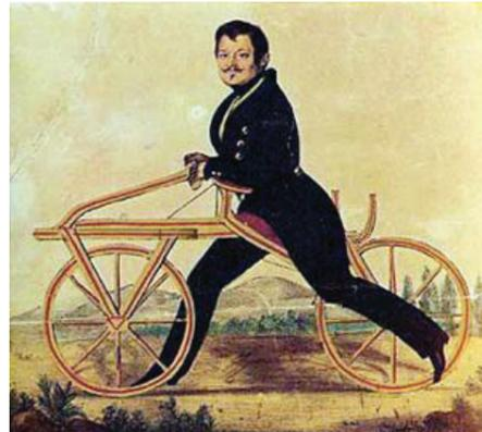
Karl von Drais auf seiner Laufmaschine. Er gilt als Erfinder des Fahrrads. Die Abbildung zeigt eine Laufmaschine die völlig aus Holz konstruiert ist.
