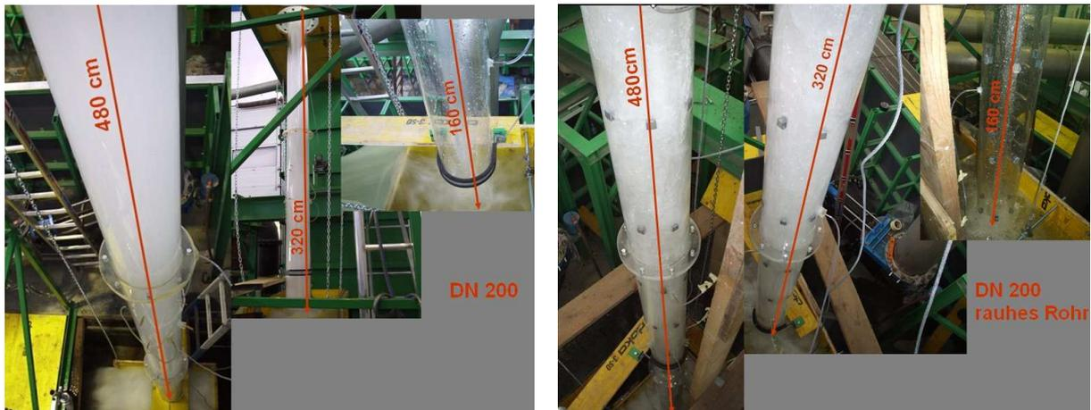
Abb. 4.22 Hydraulisch glattes und rauhes Rohr, drei Längen
