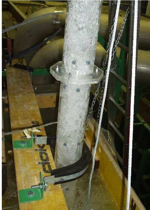
Abb. 4.12 Befestigung des Fallrohres
