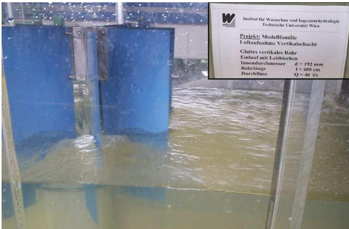
Abb. 5.6 Abflussbild bei 40 l/s, mit Leitwände (Versuch V2)
