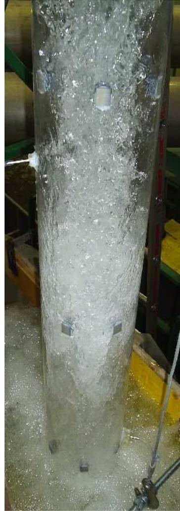
Abb. 4.15 Versuchsrohr mit eingeklebten Störkörper im Betrieb
