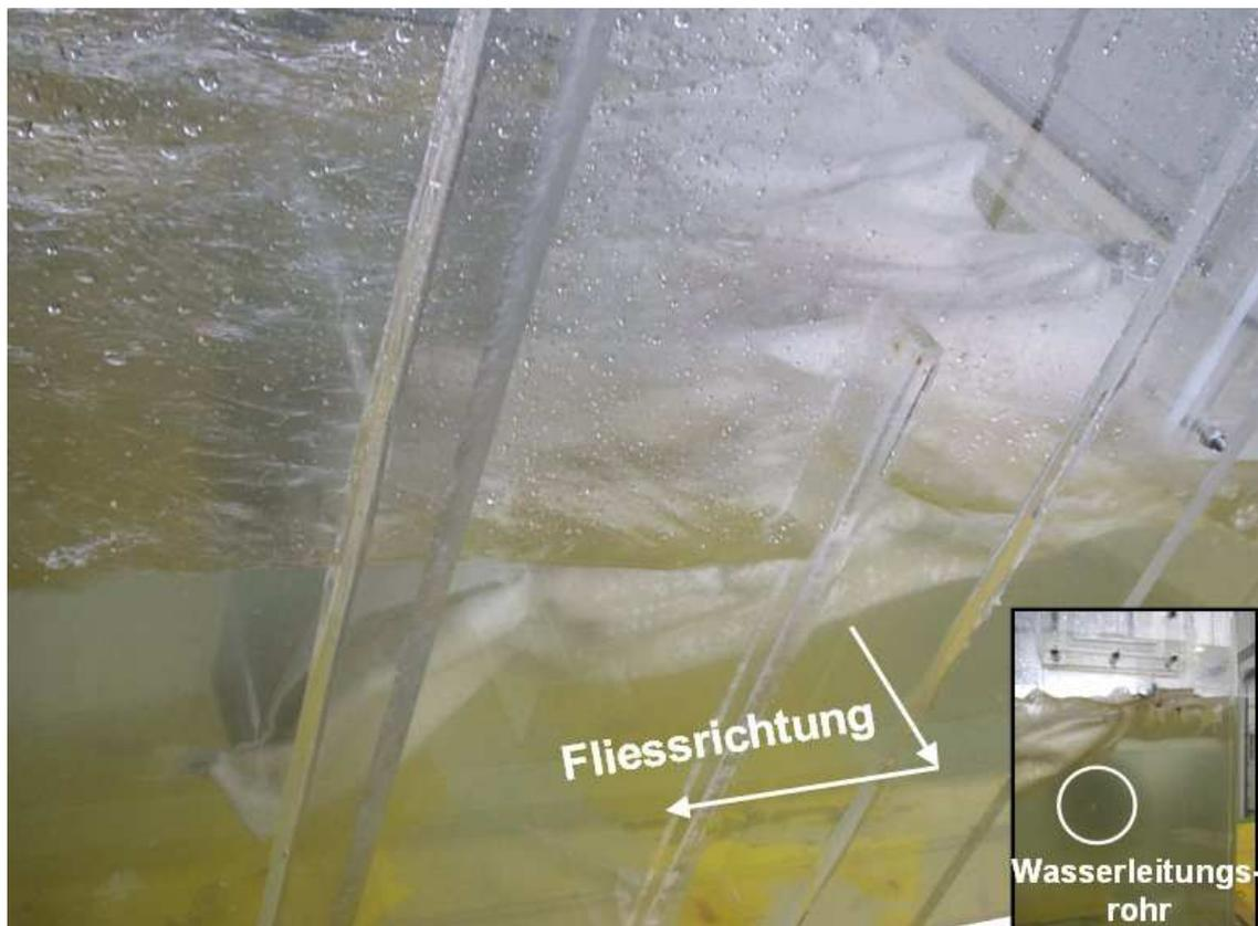
Abb. 4.7 Eingebautes Vlies zur Strömungsberuhigung
