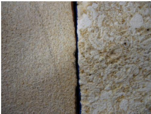
Abbildung 45: Salzausblühungen an der Oberfläche (in Form von Verkrustungen), link: Savonnières, rechts: Vicenza (Länge des Bildausschnittes ca. 5cm)
