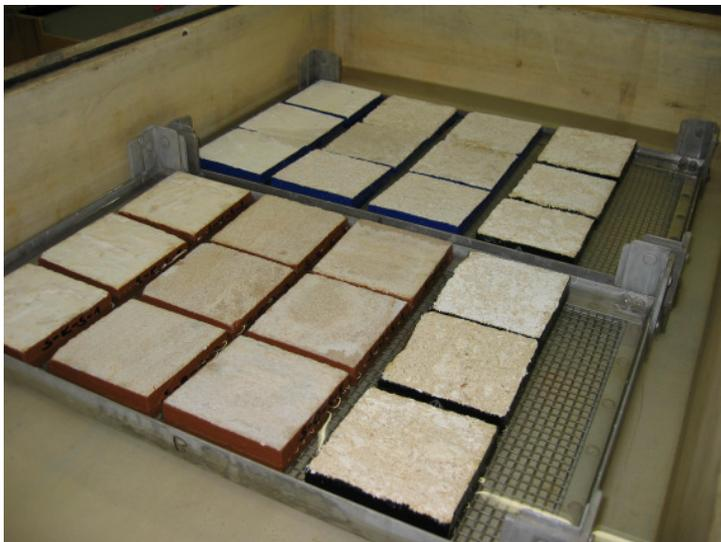
Abbildung 67: Lagerung der Probekörper im Becken, gefüllt mit Magnesiumsulfatlösung
