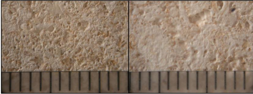
Abbildung 60: Vicenza unbeschichtet - Beschichtung mit Siliconfarbe
