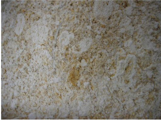
Abbildung 51: Salzausblühungen an der Oberfläche, Nano Stone Protect (Länge des Bildausschnittes ca. 5cm)
