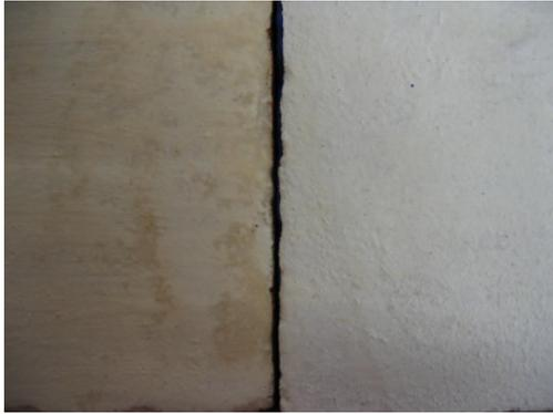
Abbildung 41: Ausblühungen an der Kalkbeschichtung nach drei Tagen, links: Savonnières (starke Vergilbung), rechts: Vicenza (Länge des Bildausschnittes ca. 5cm)
