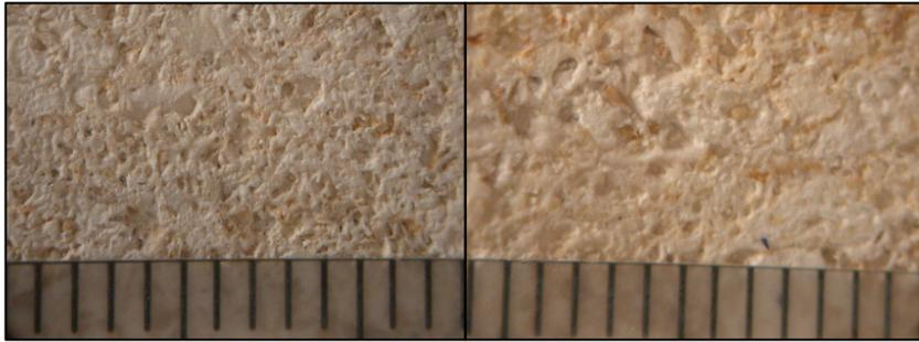
Abbildung 63: Vicenza unbeschichtet - Beschichtung mit Nano Finish A+B (1 Teilstrich im Mikroskop = 1mm)
