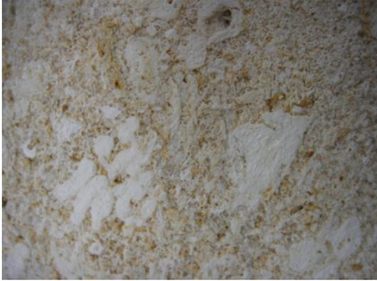
Abbildung 47: Salzausblühungen an der Oberfläche, Nano Finish A
