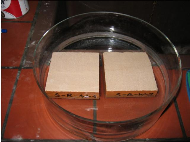
Abbildung 22: Lagerung der Proben zur kapillaren Wasseraufnahme
