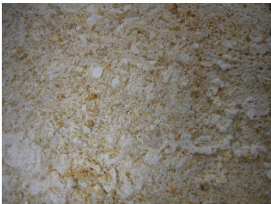
Abbildung 49: Salzausblühungen an der Oberfläche, Nano Finish A+B (Länge des Bildausschnittes ca. 5cm)
