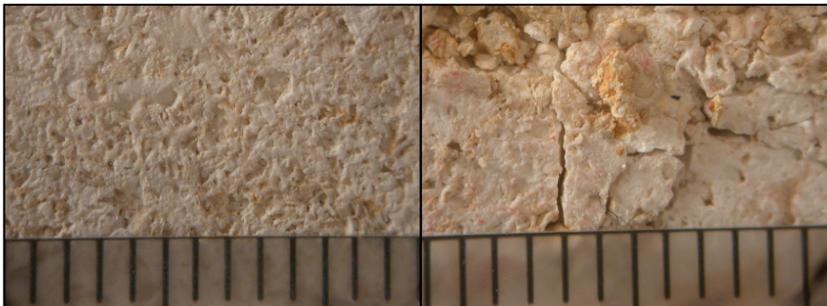
Abbildung 62: Vicenza unbeschichtet - Beschichtung mit Nano Stone Protect
