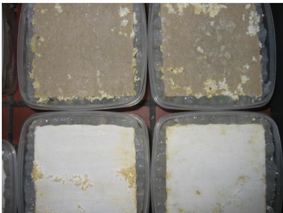
Abbildung 12: Salzausblühungen an der Oberfläche (Zogelsdorfer Kalksandstein mit Kalk- bzw. Siliconbeschichtung)
