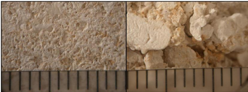
Abbildung 61: Vicenza unbeschichtet - Beschichtung mit Nano Finish A
