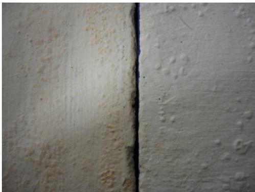
Abbildung 42: Blasenbildung der Kalkbeschichtung nach einigen Wochen, links: Savonnières, rechts: Vicenza (Länge des Bildausschnittes ca. 5cm)
