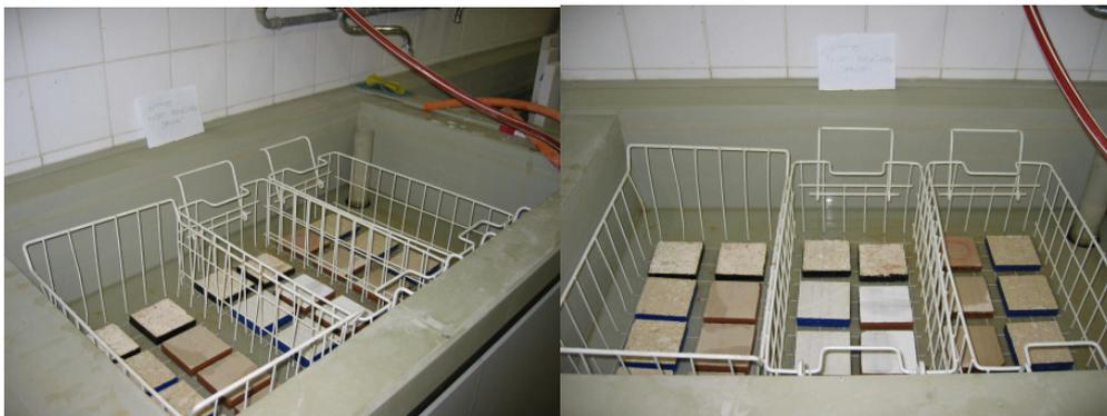
Abbildung 58: Lagerung der Proben im Becken zur kapillaren Wasseraufnahme
