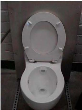
Abb. 39: Vakuumtoilette
