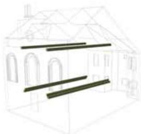
Abb. 96: Längsträger
