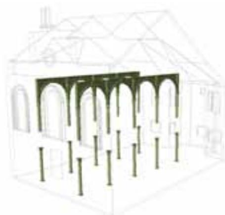
Abb. 98: Stützen und die Auflager
