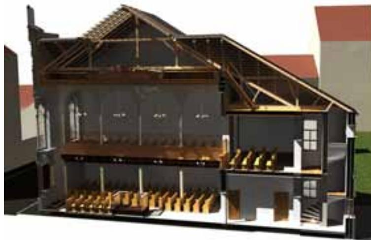
Abb. 188: Längsschnitt durch die Synagoge im ursprünglichen Zustand
