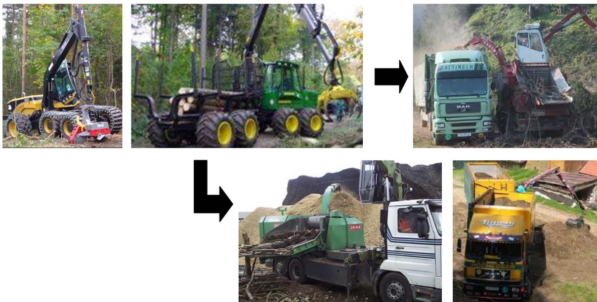
Abbildung 45: Logistikkette "Harvester, vollmechanisiert"<sup>75</sup>
