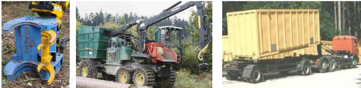
Abbildung 37: Logistikkette "Aufbauhacker auf Forwarder (Timberchipper), vollmechanisiert"<sup>66</sup>
