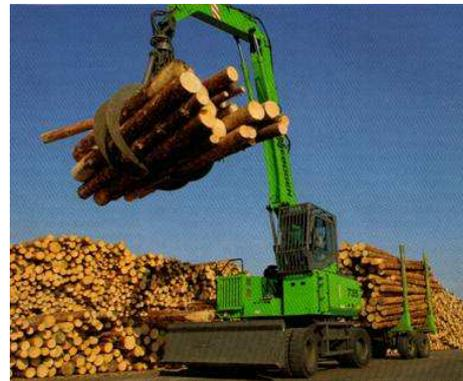
Abbildung 106: Materialumschlaggerät mit Rungenanhänger
