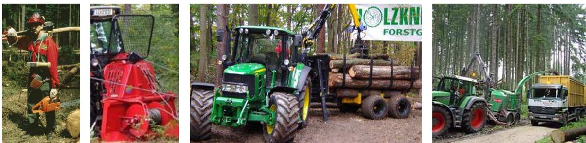
Abbildung 41: Logistikkette "Forstschlepper mit Kranrückewagen, teilmechanisiert"<sup>71</sup>
