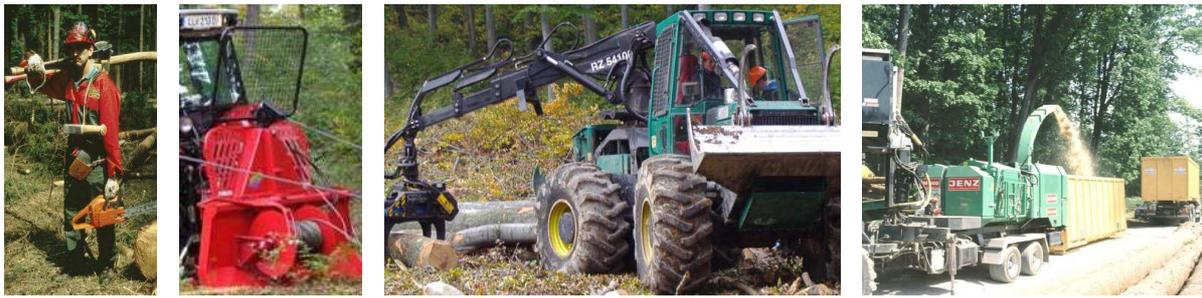
Abbildung 43: Logistikkette "Zangenschlepper, teilmechanisiert"<sup>74</sup>
