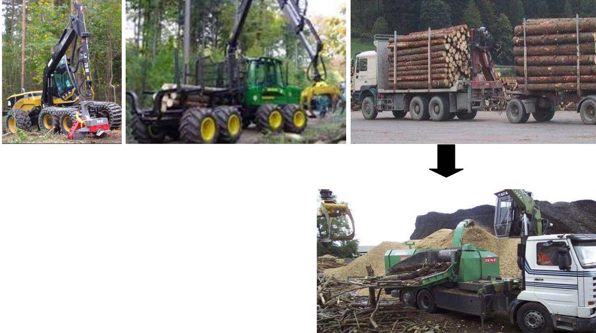
Abbildung 49: Logistikkette "Harvester - Kurzholzzug, vollmechanisiert"<sup>81</sup>
