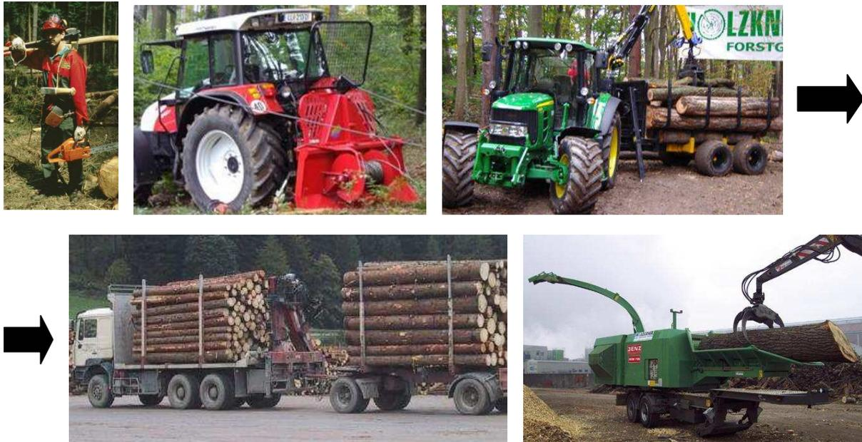
Abbildung 51: Logistikkette "Forstschlepper mit Kranrückewagen - Kurzholzzug, teilmechanisiert"<sup>84</sup>
