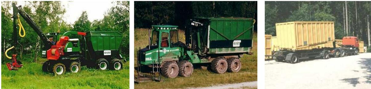
Abbildung 35: Logistikkette "Hackschnitzel - Harvester, vollmechanisiert"<sup>63</sup>
