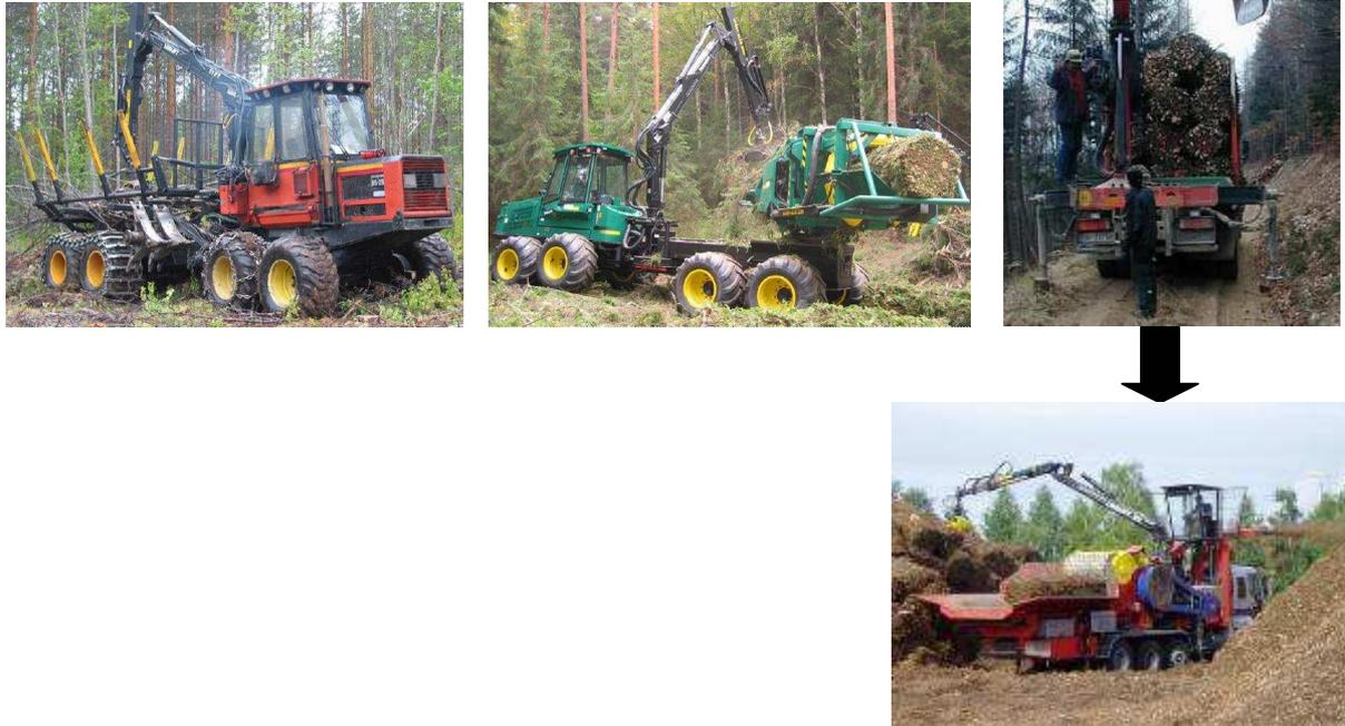
Abbildung 53: Logistikkette "Bündelmaschine - Schlagrücklass, vollmechanisiert"<sup>86</sup>
