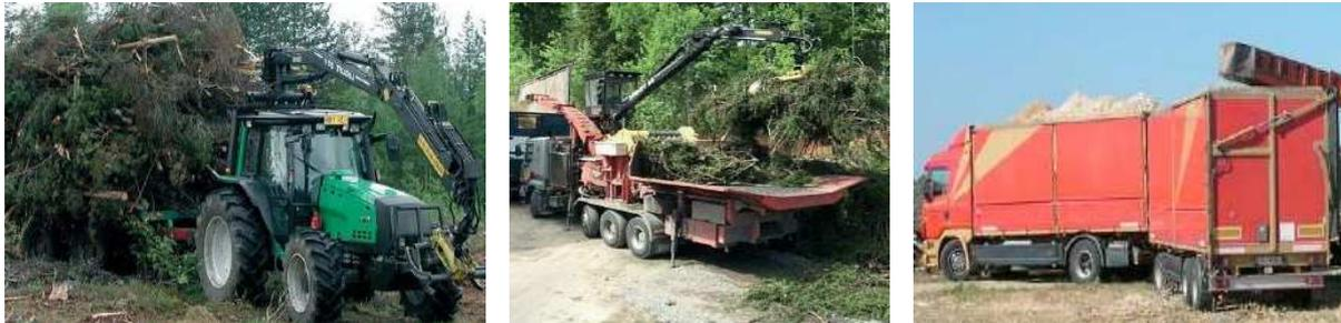
Abbildung 55: Logistikkette "Forstschlepper mit Kranrückewagen - Schlagrücklass, vollmechanisiert"<sup>89</sup>
