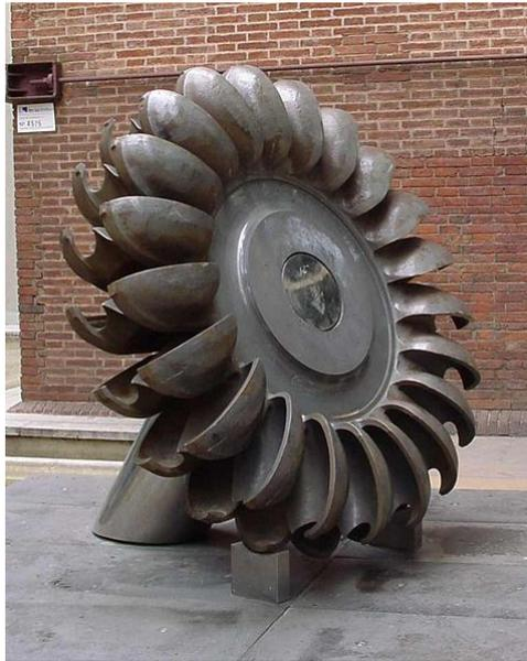
Abbildung 3.8.: Laufgrad einer Pelton-Turbine (Quelle: <http://commons.wikimedia.org>)
