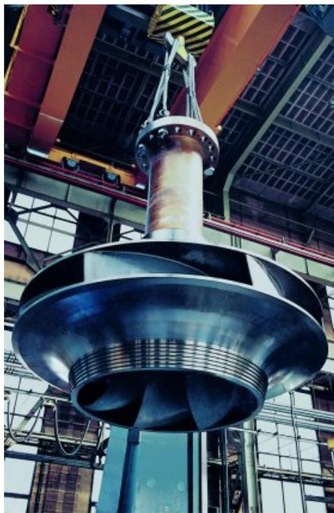
Abbildung 3.9.: Laufrad einer Pumpturbine (Quelle: <http://lnw.creamermedia.co.za>)
