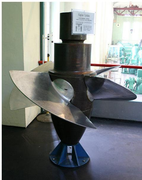
Abbildung 3.6.: Laufrad einer Kaplanturbine (Quelle: <http://de.wikipedia.org>)
