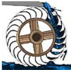
Abbildung 2.3.: Überschlächtiges Wasserrad (Quelle: <http://energie-antworten.com>)
