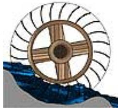
Abbildung 2.2.: Unterschlächtiges Wasserrad (Quelle: <http://energie-antworten.com>)
