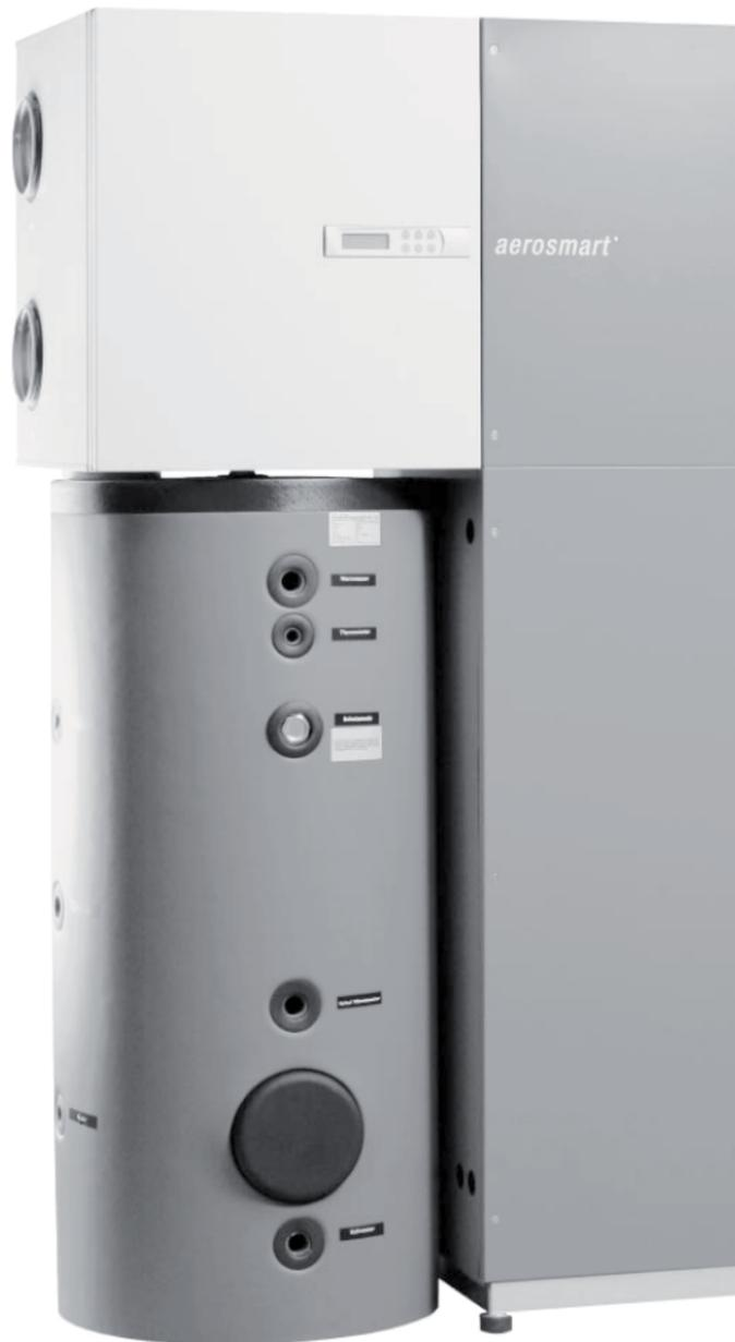
Abb.18: Kompaktgerät „aerosmart xl“, mit den Komponenten Lüftungsmodul mit Wärmerückgewinnung, Wärmepumpe für Luft- und Brauchwassererwärmung und Brauchwasserspeicher.
