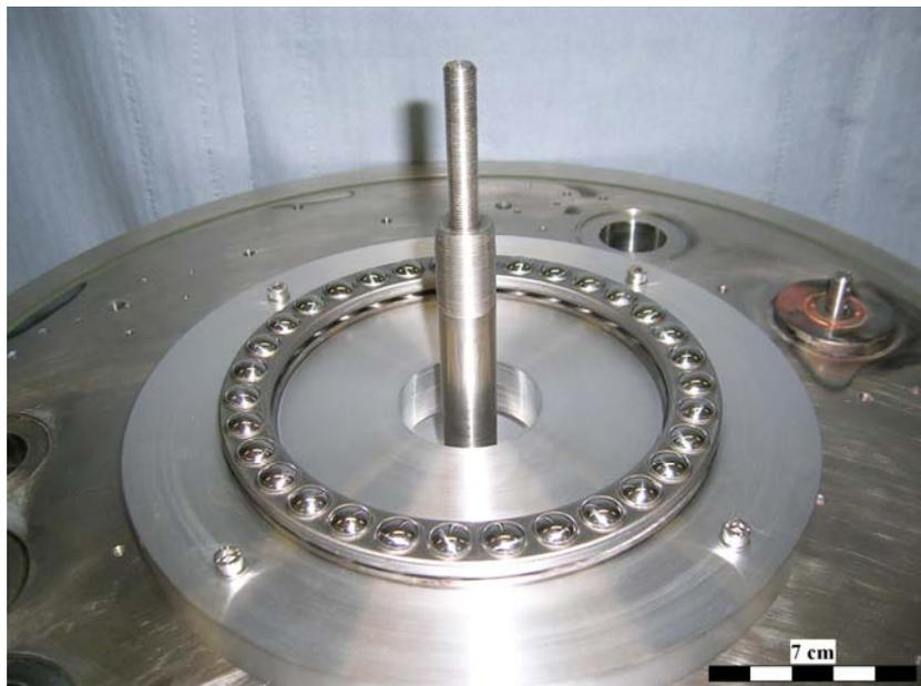
*Abb. 3.12: Unterer Teil der Baugruppe Grundplatte mit der Achse des Zentralmotors und dem Kugellagerkäfig*
