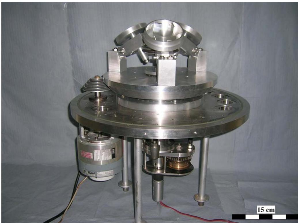
*Abb. 3.14: Gesamtaufbau der Planetenschalensputteranlage mit Motoren (unten) und Mischsystem (oben)*
