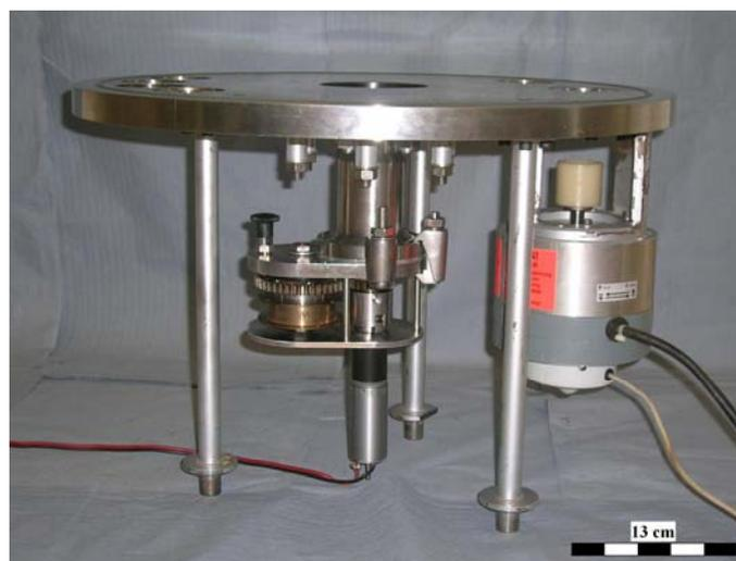
*Abb. 3.3: atmosphärensseitiger Bodenflanschaufbau: Zentralmotor und Hauptmotor (rechts)*
