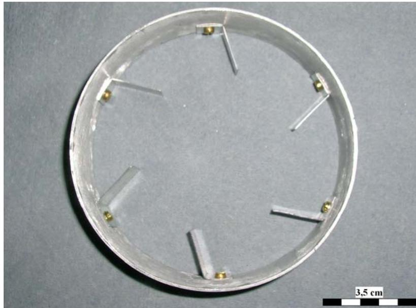
*Abb. 2.3: Ring mit sechs kurzen Einsatzblechen*
