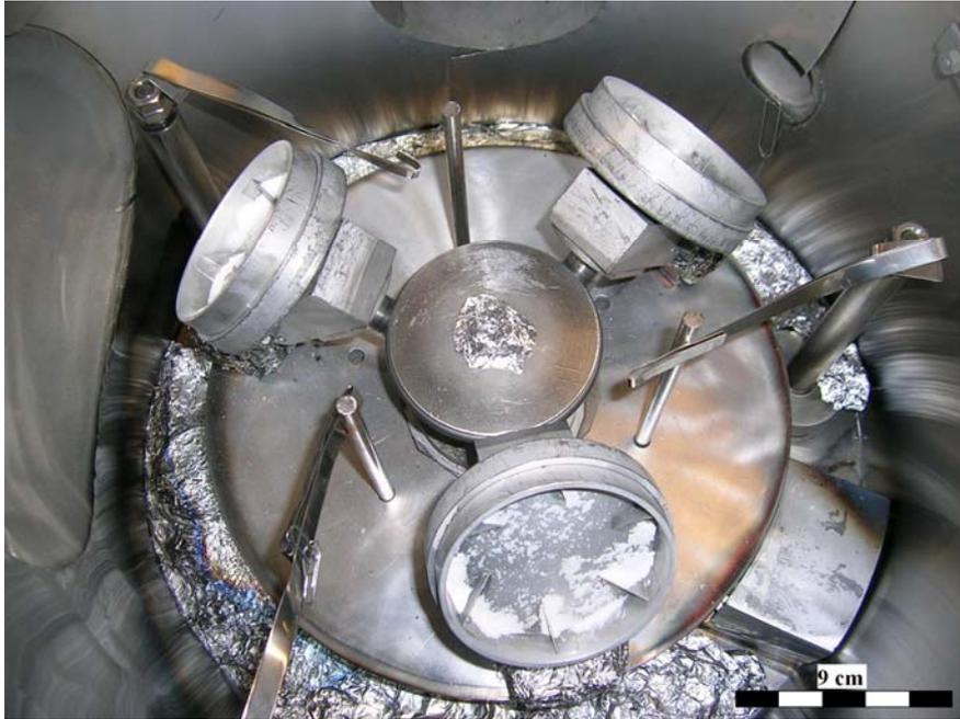
*Abb. 5.1: Auf Stahlfedern basierendes Vibrationssystem*
