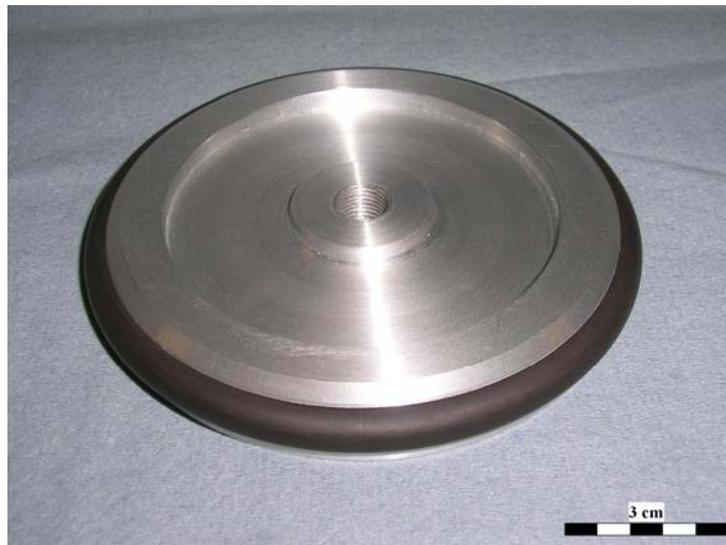
*Abb. 3.13: Unteransicht des Schalenantriebsrades mit O-Ring*
