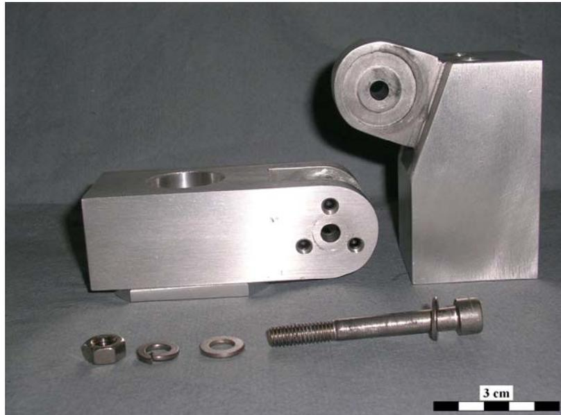
*Abb. 3.5: Trägersystem mit Achschraube im Vordergrund; die kreisrunde Ausnehmung am Innenteil des Gabelgelenkes ist die Anpressfläche für die Wurmschrauben*
