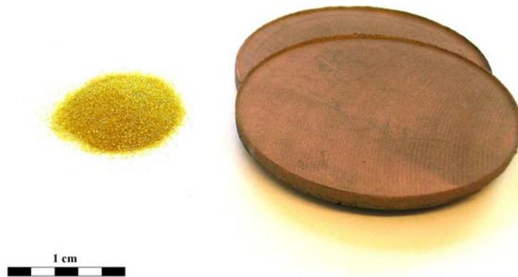
Abb. 1.2: Diamantpartikel und versinterter Kupfer-Diamant-MMC
