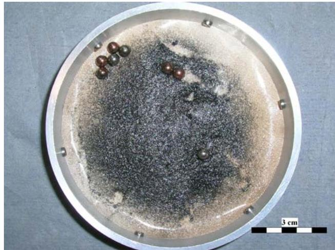
*Abb. 4.10: Schale 2 ohne Einsatzbleche, Boden mit Teflonfolie ausgekleidet,
