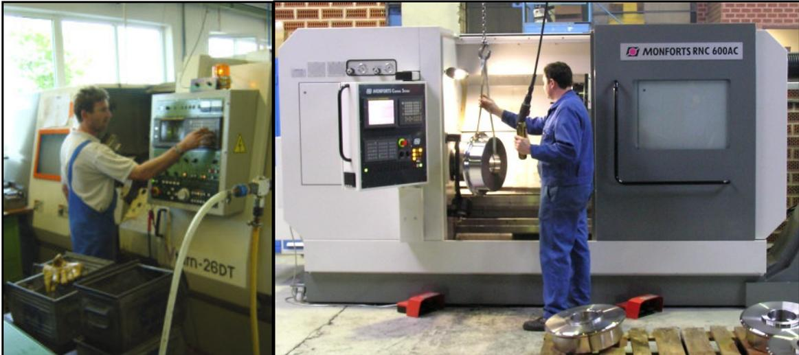
**Abbildung 23: Manuelle Beladung einer Drehmaschine [24]**
