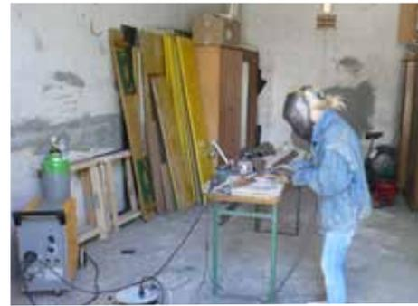
Abb.135 Herstellung der Verbindungselemente
