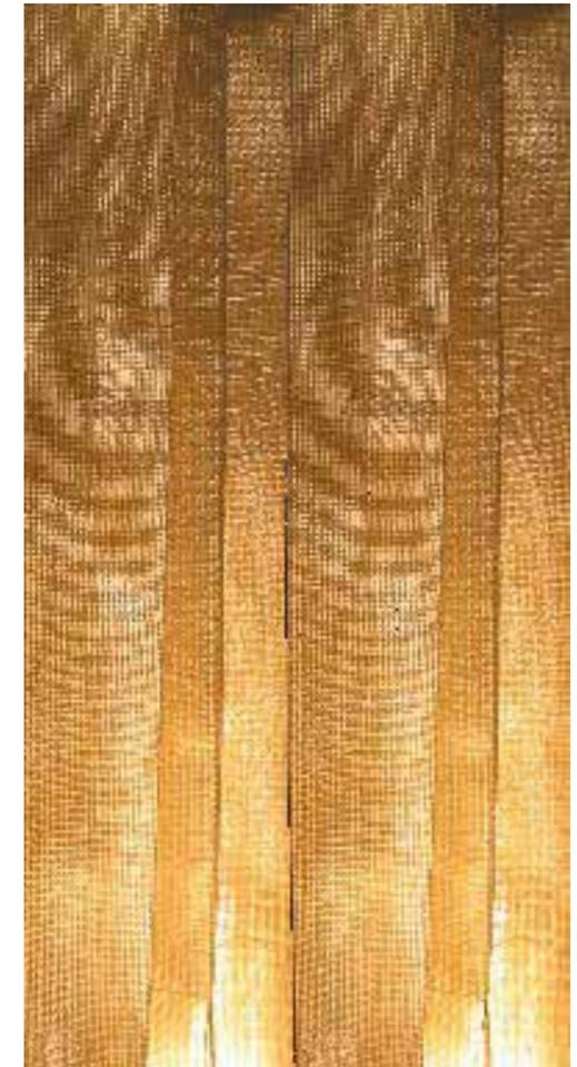
Durch die Überlagerung von zwei Gittern entsteht, wenn Licht darauf fällt, ein Moiré-Effekt. Der wird von den Jalousien genutzt, an denen die Autos in der Kurve vorbeifahren.
