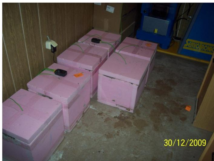
Bild 6.13: Lagerung der Probekörpern und Messung der Temperaturentwicklung
