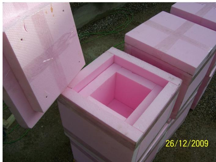
*Bild 5.17: Behälter aus XPS-G Schaumplatten*
