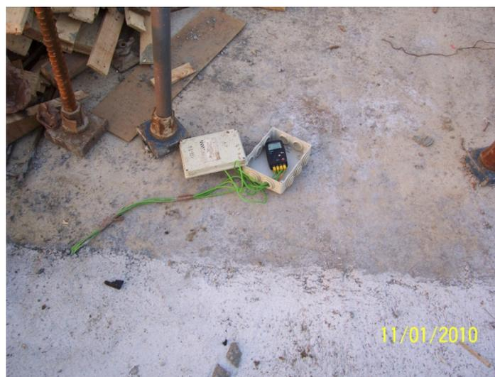
*Bild 5.9: Betontemperaturmessung mit Datenlogger TESTO 177-T4*
