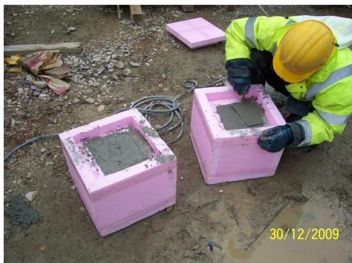
Bild 6.12: Herstellung der Probekörpern
