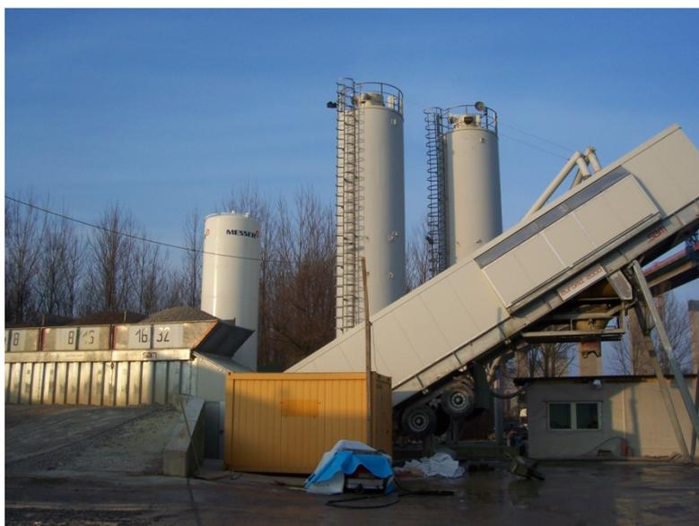
*Bild 5.3: Mobile Betonmischanlage EUROMIX 2000*
