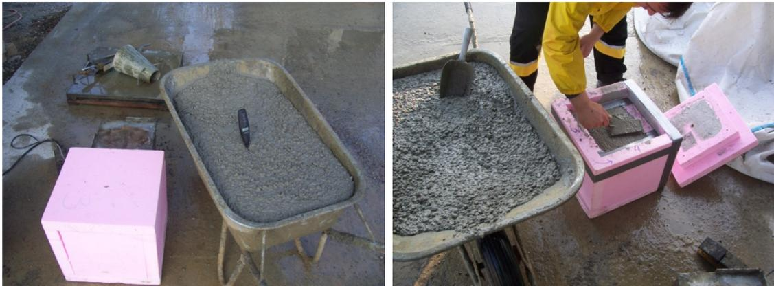
*Bild 5.18: Herstellung der Betonprobekörper*
