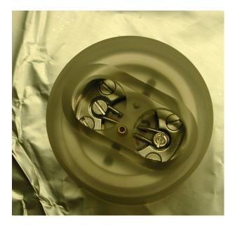
Emitter in Emitterzylinder eingesetzt (Emitter-Wechsel-Tool noch nicht abgenommen)
