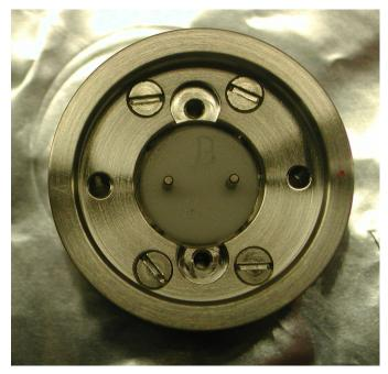
Blick von oben in den Emitter-Zylinder (Emitter eingesetzt, aber Klemmen nicht montiert)
