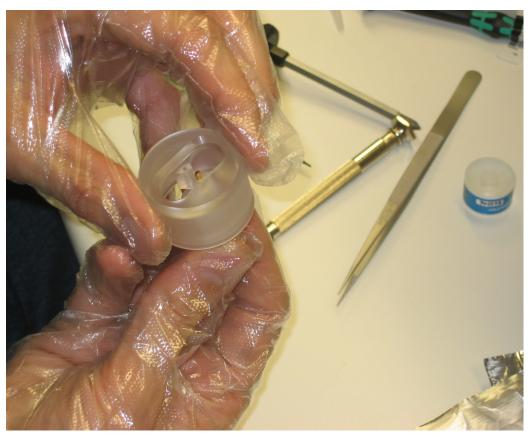
Aufnahme des neuen Emitters mit Emitter-Wechsel-Tool
