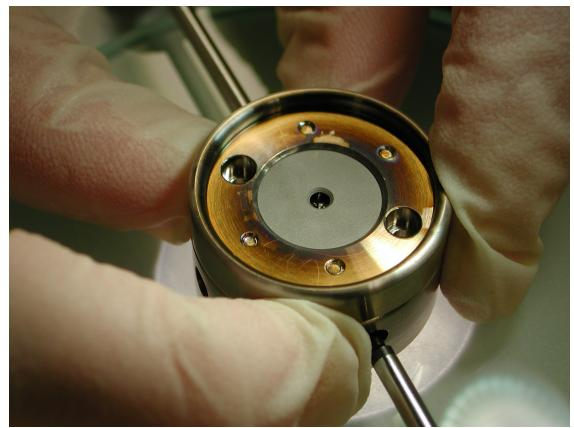
Zentrieren des Emitters (sollte unter dem Mikroskop gemacht werden)
