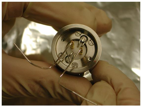
Emitter fertig zusammengebaut (vor dem Einsetzen in den LMIG-Kopf)
