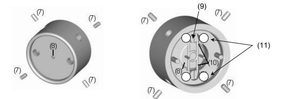
Abb. 2: Frontansicht (links) und Rückansicht (rechts) des LMIG-Suppressors (Typ I) [(7) Emitter-Justageschrauben, (8) LMIG emitter, (9) Emitter clip screws, (10) Emitter clips, (11) Befestigungs-schrauben von oberen und unteren Zylinderteil]
