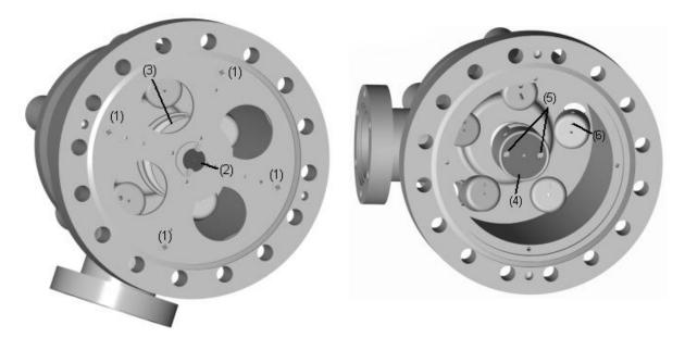
Abb. 1: Frontansicht der LMIG [ (1) Kreuzschrauben, (2) Beam defining aperture, (3) optical stack, (4), Suppressor, (5) Suppressorschrauben, (6) Sechskantschrauben]
