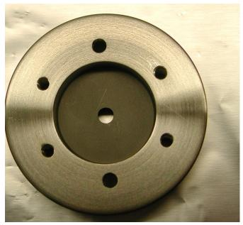
Suppressor-Apertur in Halterung eingesetzt (im Unterteil des Emitter-Zylinders enthalten)
