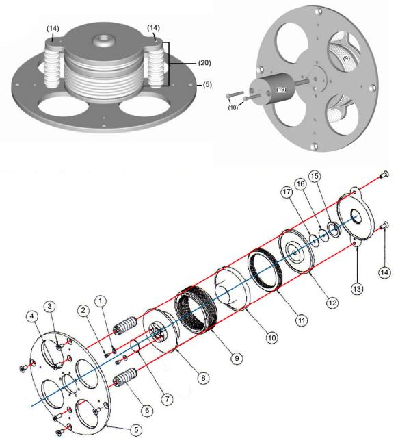
Abb. 3: Ionenoptik der LMIG (oben Seitenansicht und unten Detailansicht)
