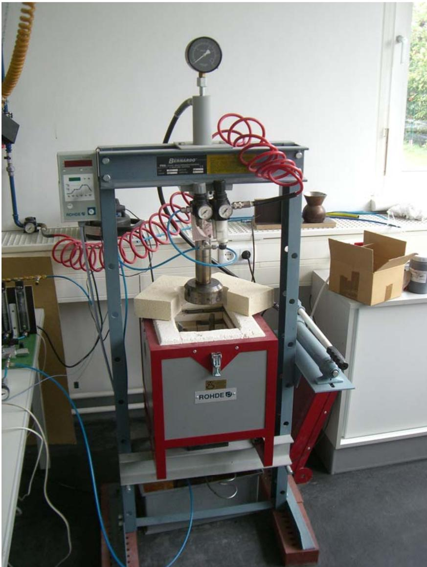
Abbildung 2-18: Werkstattpresse mit eingebautem Ofen
