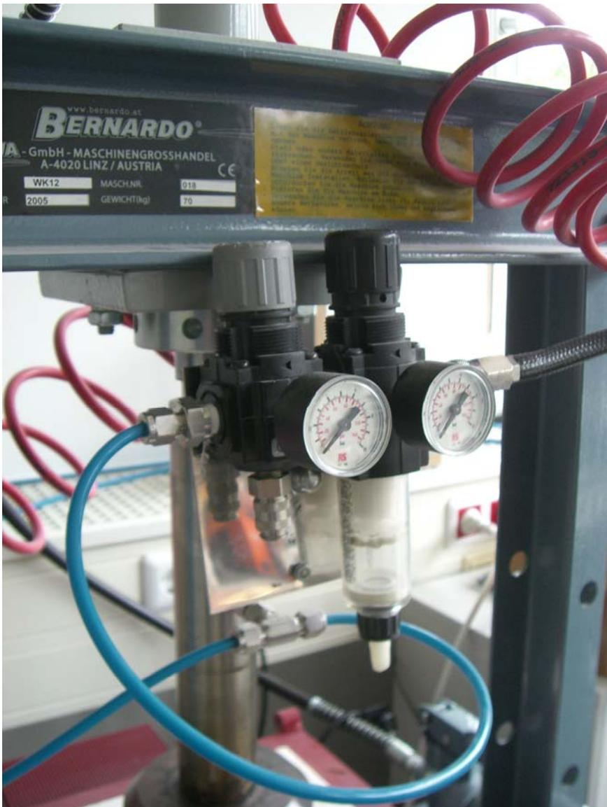
Abbildung 2-19: Filterregler mit Druckübersteuerungsmodul
