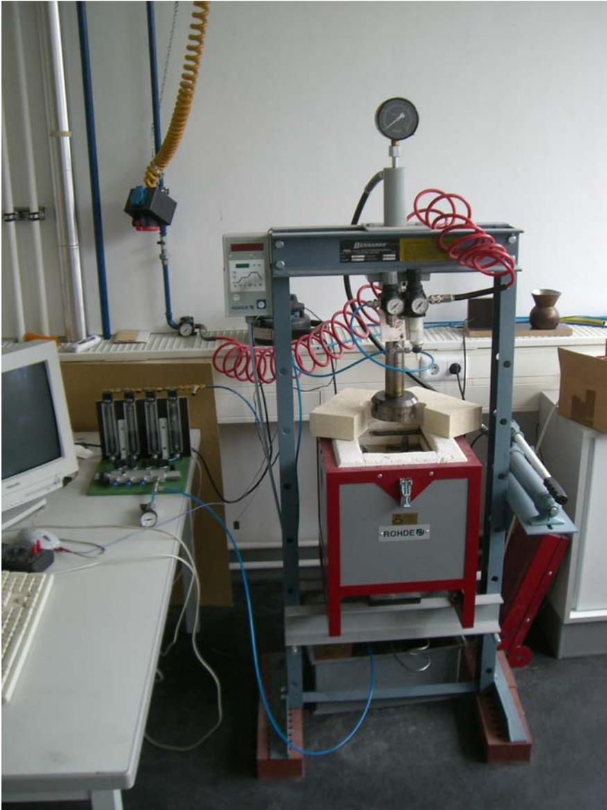
Abbildung 2-15: Messanlage zur Bestimmung der Permeabilität unter Temperaturbelastung
