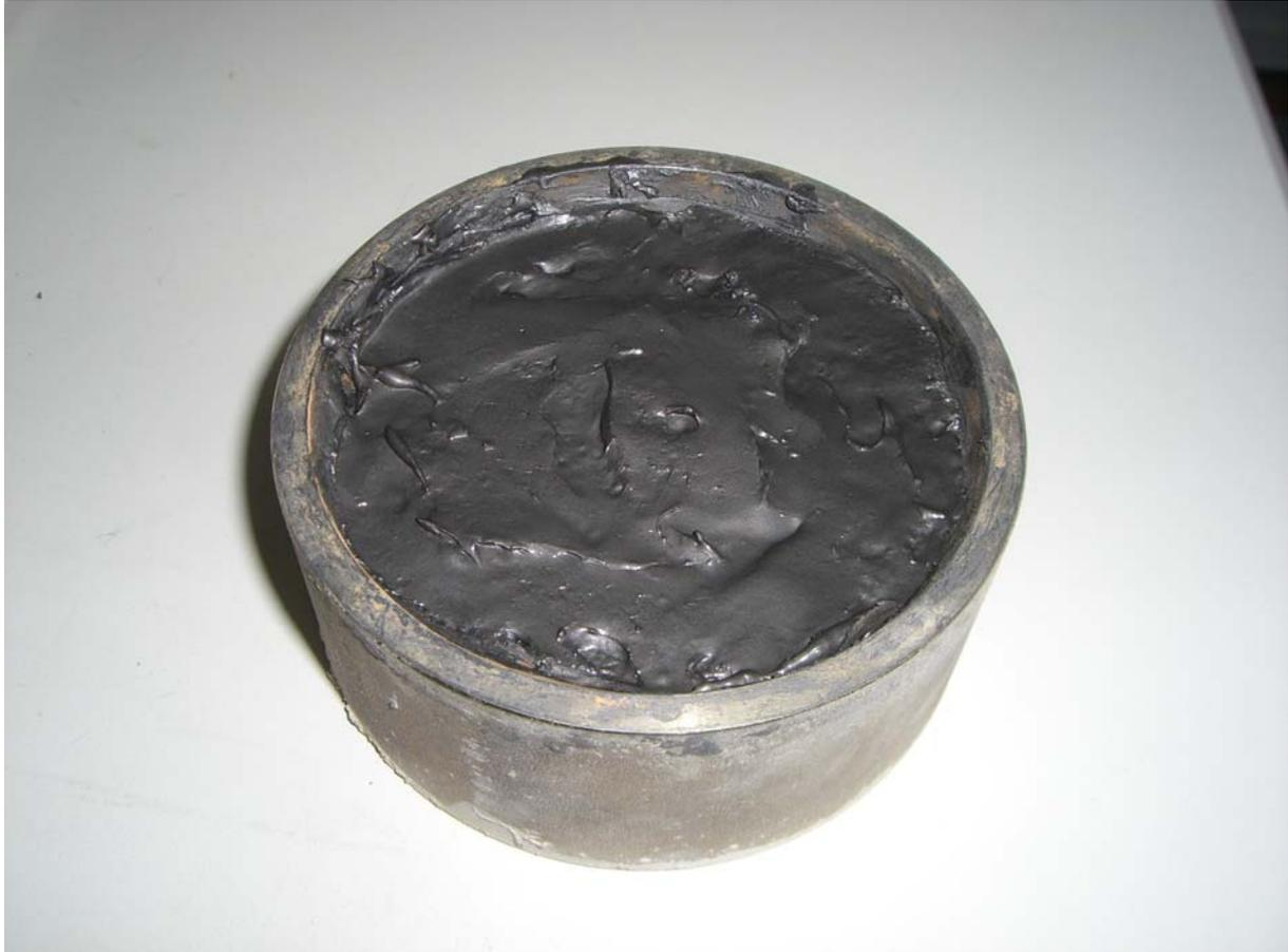
Abbildung 4-1: Probekörper für die Messung der Dichtigkeit der Anlage
