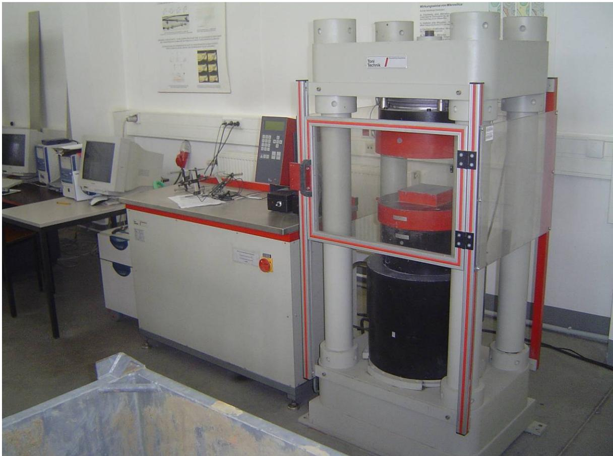
Abbildung 5-1: TONI Technik Prüfmaschine zur einaxialen Druckfestigkeitsuntersuchung (Gornik, /3/)
