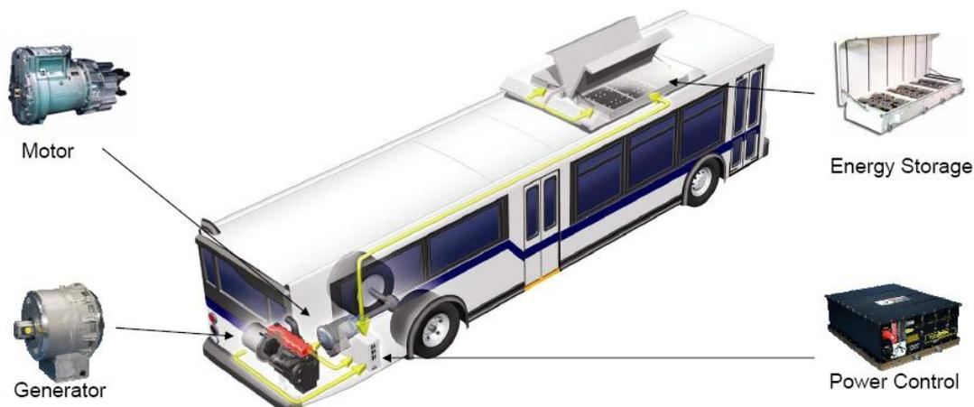
Abb. 25: Das BAE HybriDrive System in einem Orion VII Stadtbus aus [37]
