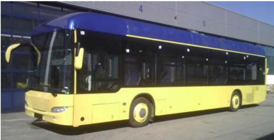
Abb. 32: Oberleitungsbuss *N6216* von *Viseon* mit dieselelektrischem Zusatzantrieb
