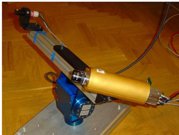
**Abbildung 1.4:** Der bestehende Tiefenbildsensor: Die wichtigsten Bestandteile des am Institut existierenden Tiefenbildsensors sind eine „MAPP 2500“ Kamera von IVP und eine Schwenk-/Neigeeinheit „PowerCube“ von AMTEC.
