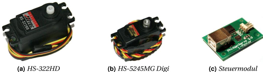
**Abbildung 6.6:** Die beiden getestete Servos mit der Steuerung: (a) Der analoge Standardservo HS-322HD von Hitec zeichnet sich durch seinen günstigen Preis aus. (b) Der kleinere Hitec HS-5245MG Digi ist einer der wenigen digitalen RC-Servos, der mit den 450mA, die das Steuermodul liefern kann, arbeitet. (c) Für die Ansteuerung der RC-Servos wird das USB-Modul „PhidgetServo 1-Motor“ verwendet.
