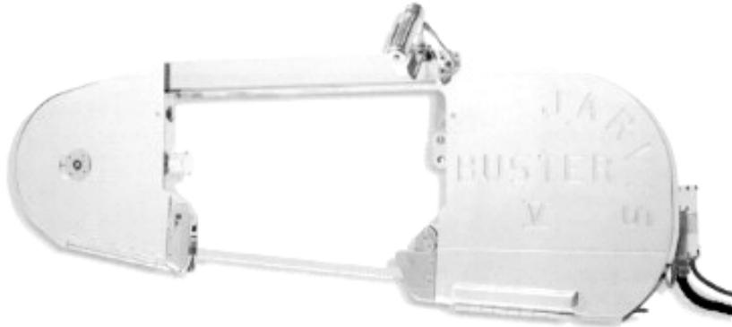
**Abb. 3.4: Bandsäge zum Spalten von Schlachtvieh<sup>105</sup>**
