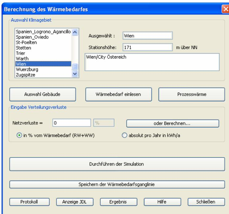
Bild 43: Dialogfeld Wärmebedarfsberechnung <sup>21</sup>
