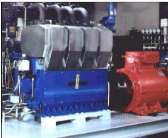
Bild 30: Anlagenbeispiel eines *Spilling* Dampfkolbenmotors [30]
