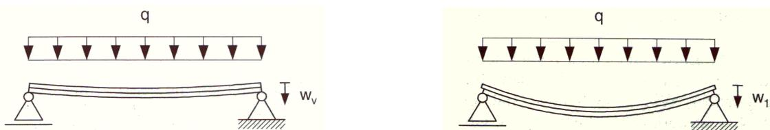
Abbildung 11 und 12: Verformung einer Verbundglasscheibe bei vollem Schubverbund (links) und bei fehlendem Schubverbund (rechts) (Wrner, S. 153f, [31])
