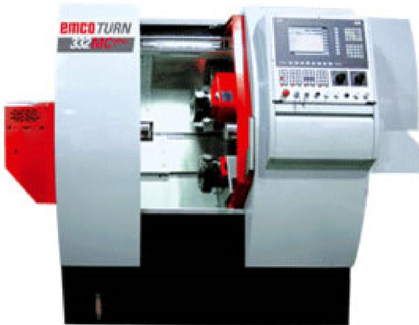
Abb. 29 EMCO turn 332 ohne Späneförderer und Stangenlader<sup>65</sup>
