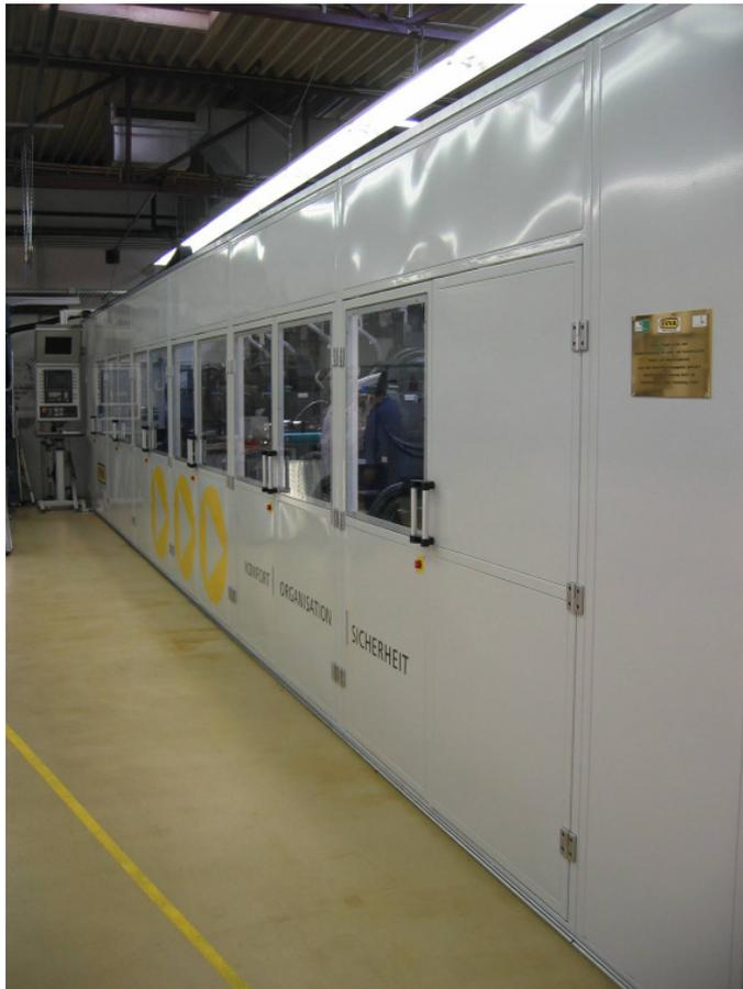
**Abb. 69** noch im Bau befindliche CNC-Lineartransfermaschine Nike-Valerie
