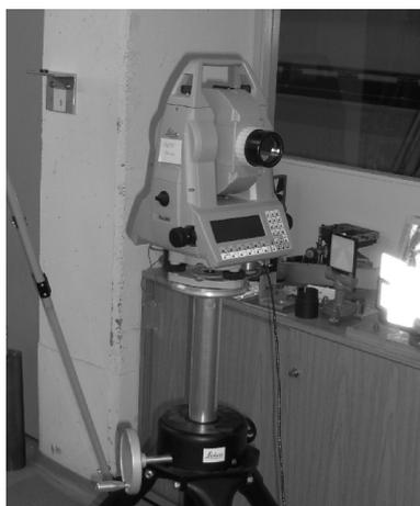
(a) TCA2003 mit zusätzlichem Autokollimationsspiegel, montiert auf dem Fernrohr
