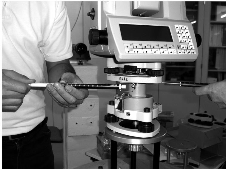
**Abb.:** 5.3: Messaufbau zur Bestimmung der DreifuÙhysterese
