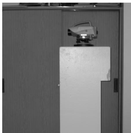
(b) DNA03 auf einem Messpfiler aufgebaut
