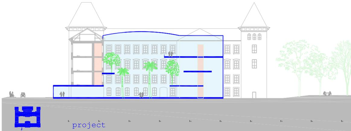
Abb.: Schnitt durch den Innenhof als Variante mit Glasdach
