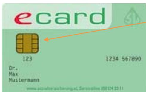
Die erste Funktion dieser **Goldkontakte** besteht darin, die Karte mit Strom zu versorgen. Die Zweite gewährleistet den Datentransfer von der Karte zum Rechner und wieder zurück. [a5]
