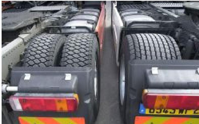
**Abbildung 3 – Zwillingstreifen und überbreiter Einzelreifen**
