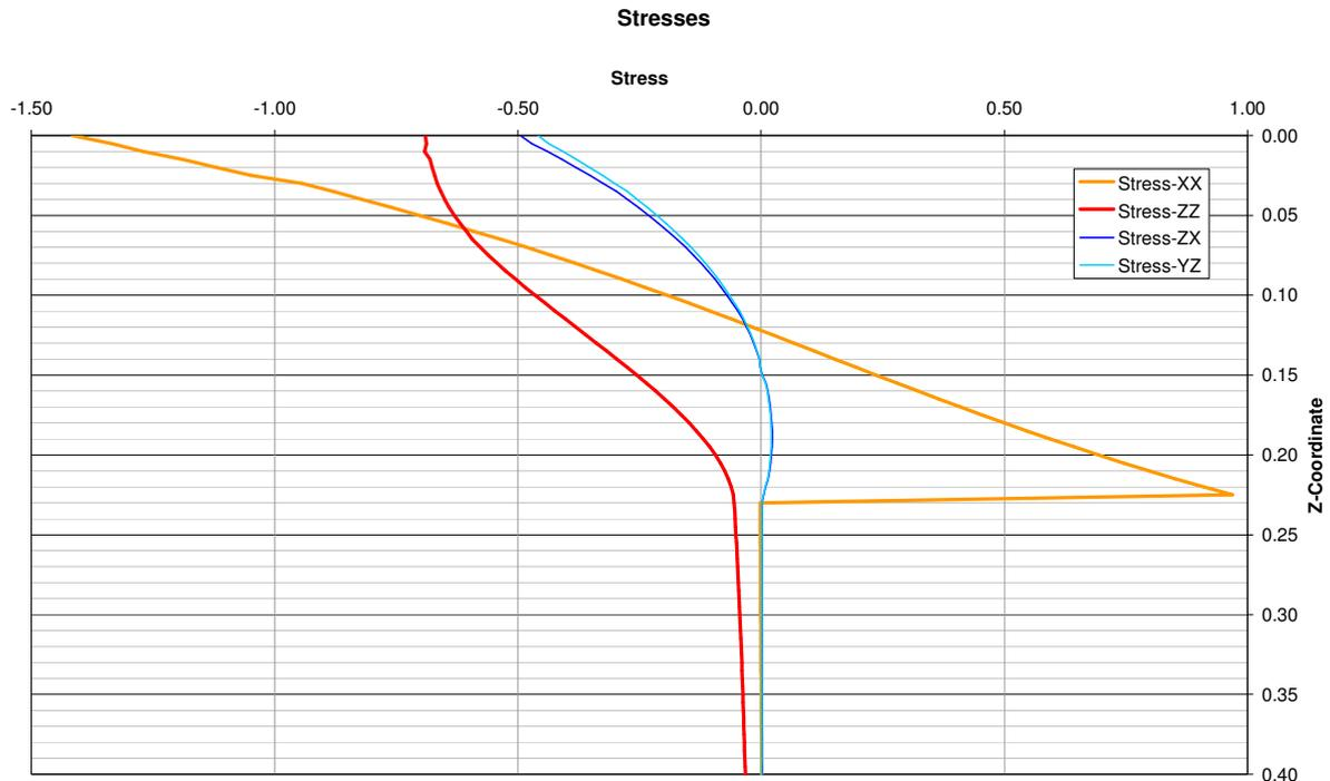
**Abbildung 50 – Beispieldarstellung für einen errechneten Spannungsverlauf im Straßenkörper**
