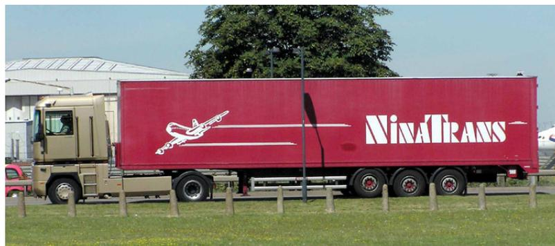
**Abbildung 13 - Sattelkraftfahrzeug: Zugmaschine und Auflieger ([wikipedia.org](http://wikipedia.org), 2008)**
