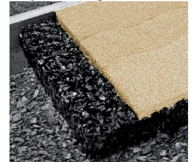
WETPOUR WIRD ALS FALLSCHUTZ IM INNEN- UND AUSSENBEREICH EINGESETZT. BESTEHEND AUS ZWEI SCHICHTEN, ABSORBIERT DIE UNTERE SCHICHT DEN AUFPRALL, DIE OBERE SCHICHT IST UV- BESTÄNDIG UND SCHÜTZT VOR ABNUTZUNG. BEI EINER MAXIMALEN FALLHÖHE VON 3M BEDARF ES EINEM WETPOUR BODENAUFBAU VON 14CM.
