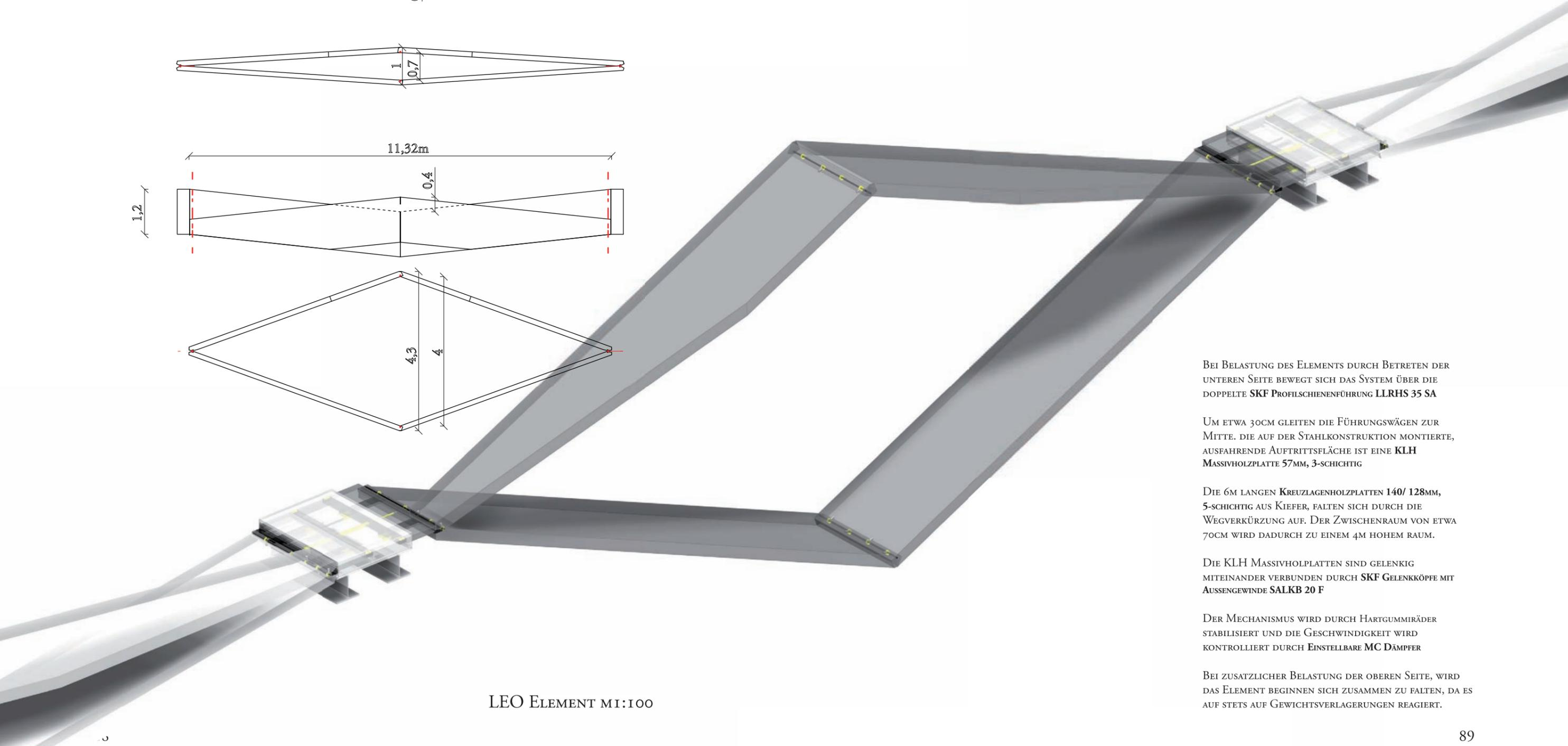
BEI BELASTUNG DES ELEMENTS DURCH BETRETEN DER UNTEREN SEITE BEWEGT SICH DAS SYSTEM ÜBER DIE DOPPELTE SKF PROFILSCHIENENFÜHRUNG LLRHS 35 SA
