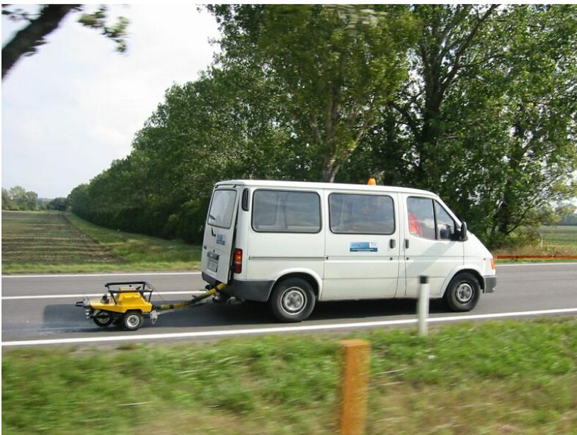
Abb. 4-2: GripTester im Zugbetrieb [ISTU-Archiv]
