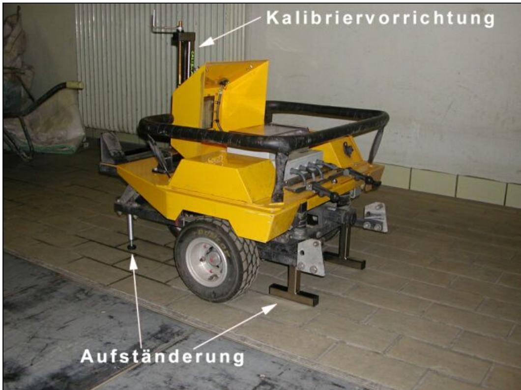
Abb. 4-29: Aufständerung des GripTester für die Komplettkalibrierung [ISTU-Archiv]
