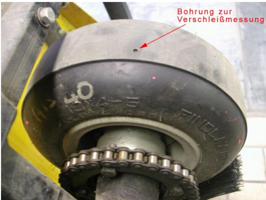
Abb. 4-4: Messreifen – profillos, mit Bohrung zur Verschleißmessung [43]
