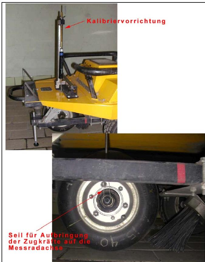
Abb. 4-31: Vertikale Kalibrierung [ISTU-Archiv]
