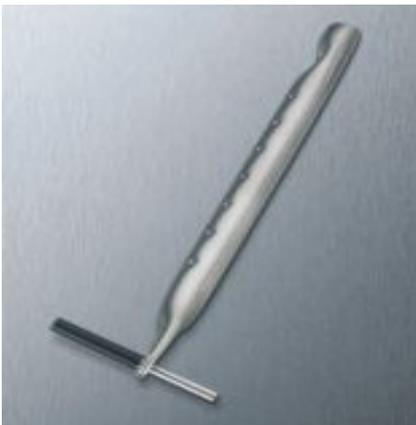
Der Naturwerkstein-Einmörtelanker ist aufgrund seines Rohrquerschnittes bestens für den Verankerungsgrund Mauerwerk geeignet, kann aber ebenso im Beton eingesetzt werden. Die Traganker sind für die vertikale und horizontale Plattenfuge gleich ausgeführt. Entsprechende Halteanker zum Abtragen von Wind- und sonstigen Horizontalkräften gehören ebenso zum Verankerungssystem.
