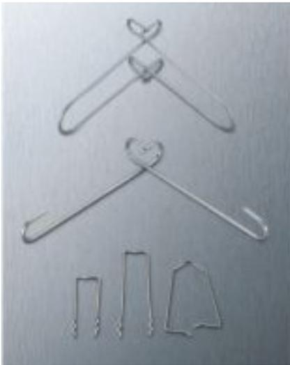
Sandwichanker haben die Aufgabe, Trag- und Vorsatzschicht einer mehrschichtigen Beton-Fassadenplatte miteinander zu verbinden und das Eigengewicht der Vorsatzschicht sowie die auf sie einwirkenden Beanspruchungen in die Tragschicht abzuleiten. Da die Anker im Luft- bzw. Dämmschichtbereich der Korrosion ausgesetzt sind, werden sie aus nichtrostendem Stahl hergestellt. Neben den Tragankern werden noch Verbundnadeln bzw. Verbundbügel verwendet, die eine Verwölbung der Vorsatzschicht verhindern.
