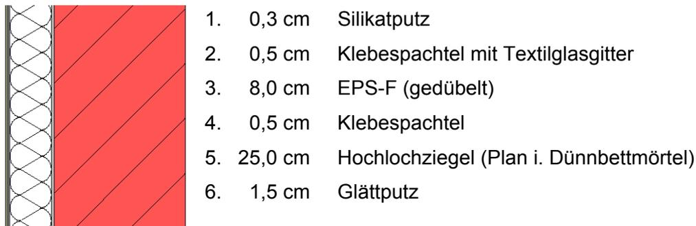
**Abb. 6.1-3: B1 - Mauerwerk / Silikatputz[WF]**
