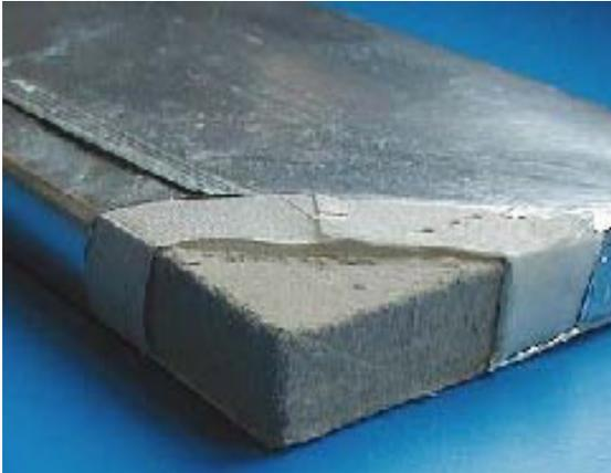
**Abb. 4.3-8: Aufbau eines VIP[90]**
