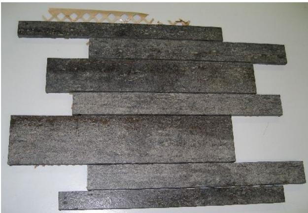
Abb. 4.7-2: Keramische Fliesen auf Trägerpapier[WF]
