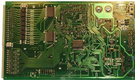
Abbildung 28: Bestückter Prototyp (V2; Ober- und Unterseite)
