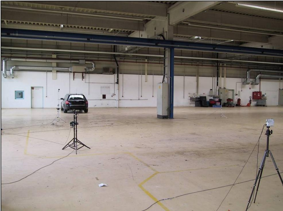
Bild 15 Messaufbau – Mikropositionen 1 bis 4 innen & Lichtschranke
