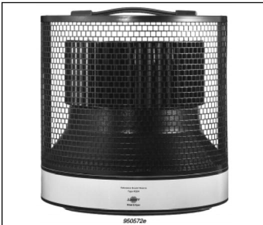
Die Referenzschallquelle erzeugt durch ein rotierendes Gebläse einen genau definierten Druckpegel. Dieser wird als Schall empfunden. Für die Referenzschallquelle wird vom Hersteller folgender Emissionswert angegeben:
