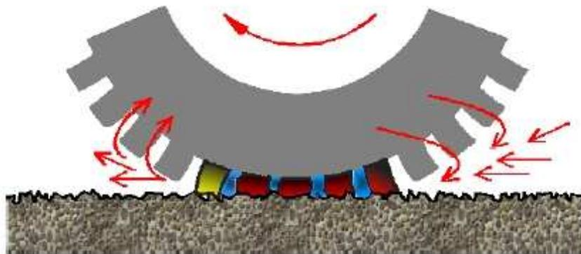
Abb. 6.16: Entstehung des Abrollgeräusches mittels „Air Pumping“.
