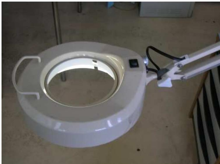
*Abb. 4.7: Die verwendete Lupenleuchte. Aus der kreisförmigen Öffnung in der Mitte wurde das Lupenglas entfernt.*
