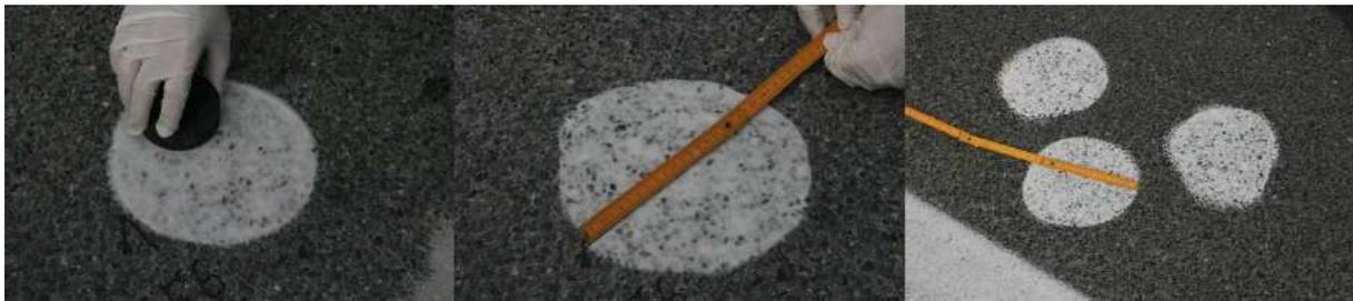
*Abb. 3.1: Praktische Ausführung der Sandfleckmethode. [ÖNORM-EN-13036-1]*
