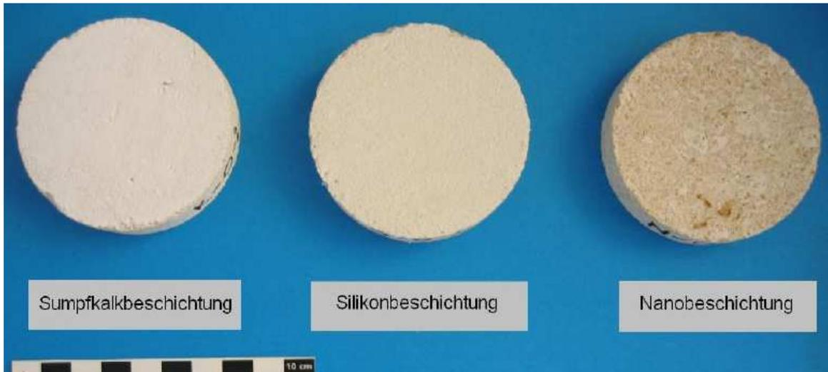
Abb. 6.17: Die unterschiedlichen Beschichtungen. [GRÄF V., 2008]
