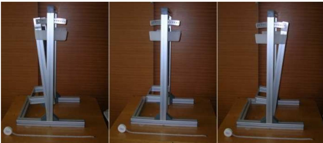
Abb. 4.6: Der Rahmen aus der Seitenperspektive. In den drei Ausschnitten wird das Verkippen des Innenrahmens von links nach rechts dargestellt.
