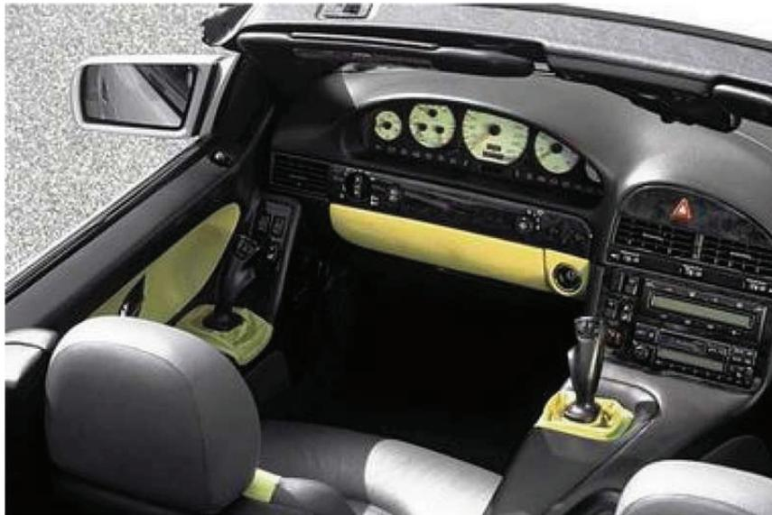
Abbildung 2.10: Steuerung durch Sidesticks, verwendet im umgebauten Mercedes SL der Baureihe R129
