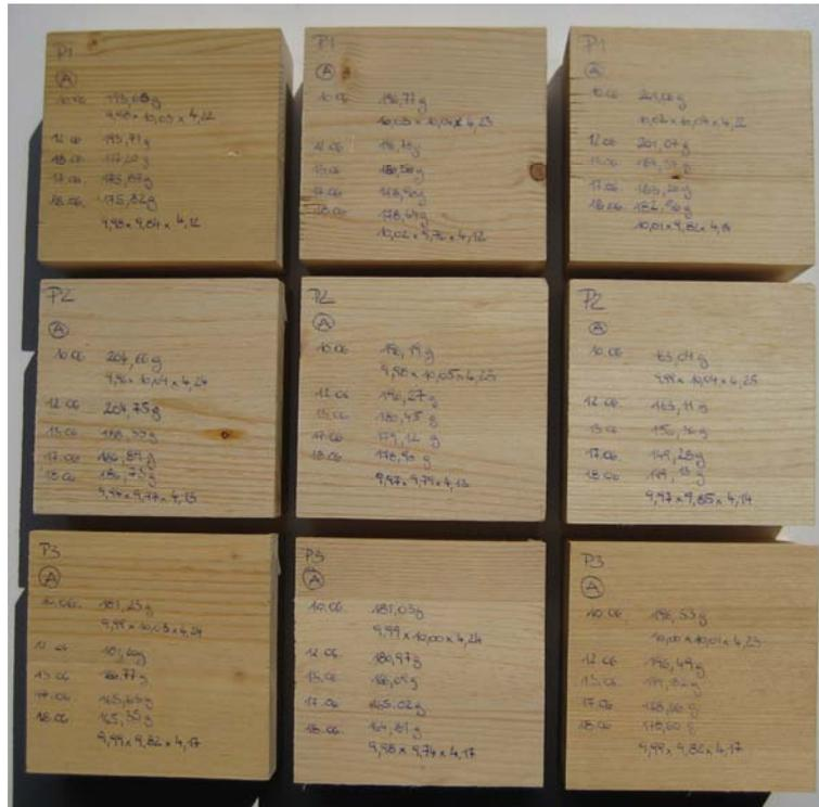
Abbildung 4.8: Holzquader zur Bestimmung von Holzfeuchte und Dichte für Klima A
