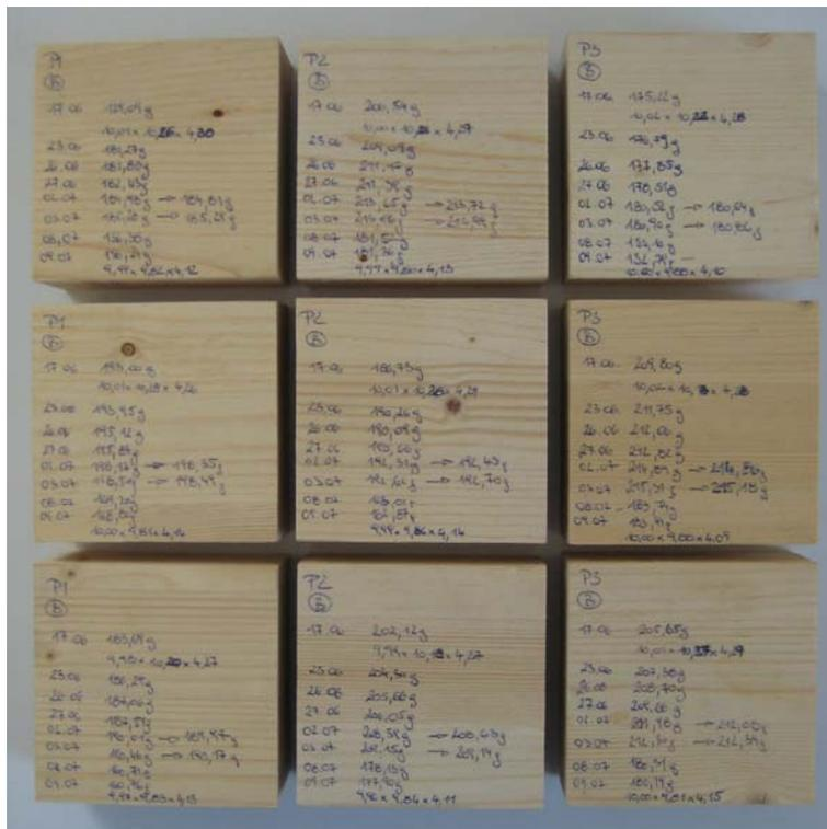
Abbildung 4.9: Holzquader zur Bestimmung von Holzfeuchte und Dichte für Klima B
