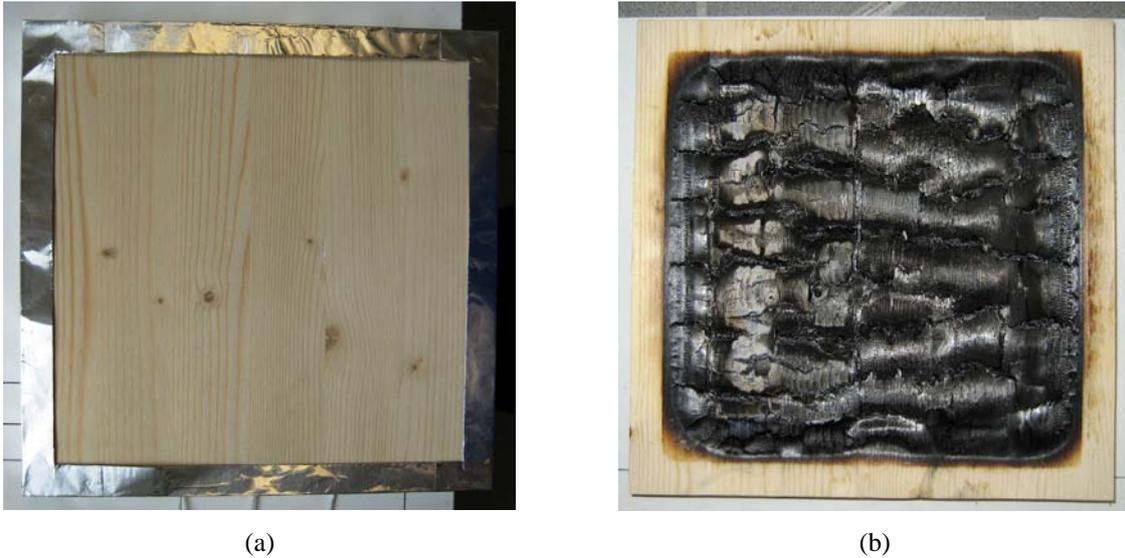
Abbildung 5.3: Probenholz 1.A.02 vor (a) und nach (b) dem Brandversuch
