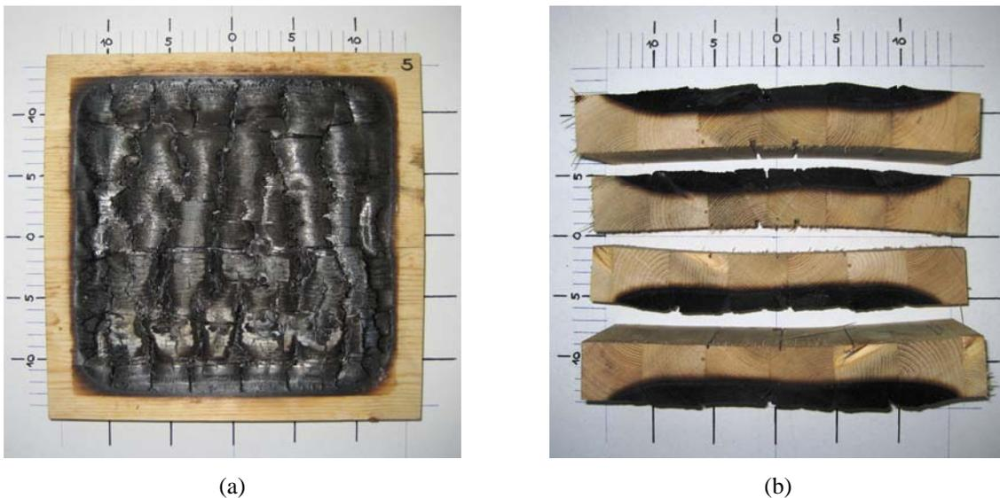
Abbildung 5.4: Rissbild (a) und Abbrandtiefe (b) von Probekörper 1.A.02
