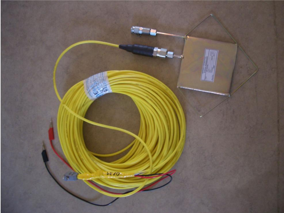
Abbildung 5-1: Hydraulisches Druckkissen vom Typ Behensky
